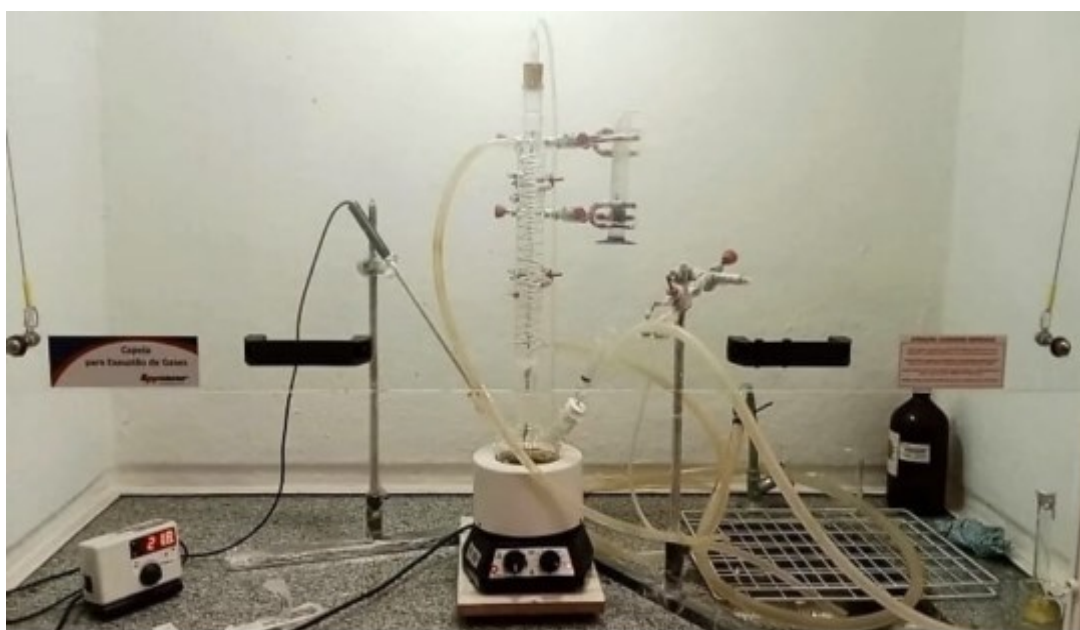
Figura 11 - Montagem experimental utilizada para o início da formação do precipitado em andamento, conduzida dentro da capela para garantir segurança e controle de todo o processo de síntese. (autoria própria)
