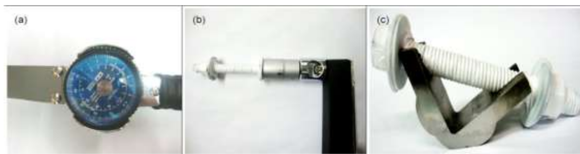
Figura 3.33 – Etapas para restringir as amostras com torquímetro: (a) Torquímetro com torque máximo de 9.0 N.m; (b) Amostra submetida ao torque de 8.8 N.m; (c) Amostra restrita com torque de 8.8 N.m
