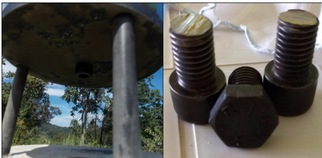
Figura 10 – Adaptadores para o encaixe da estação e base nivelante no marco de centragem forçada
