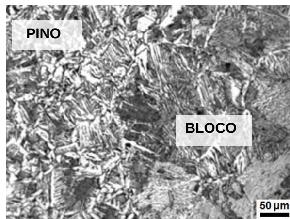
Figura 2 – Micrografias da amostra 31604 (120 kN, FN de 0,0 mm, FR de 1,9 mm e Cq 7,0 mm); A) Mostra a interface pino/bloco a 5,0 mm da face inferior do bloco; B) Mostra a interface pino/ bloco a 10 mm da face inferior do bloco
