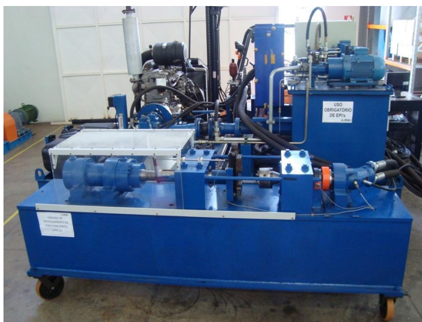
Figura 2. 16 – Unidade de Processamento de Pinos por Atrito 3 (GONTIJO, 2012)
