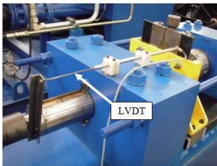
Figura 3. 8 – Posicionamento do sensor de deslocamento (LVDT)
