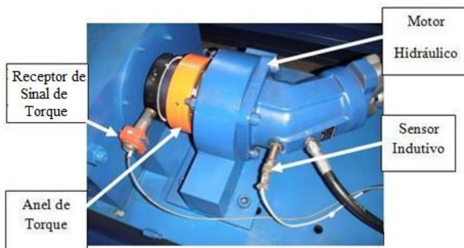
Figura 3. 6 – Posicionamento do receptor de sinal de torque, sensor indutivo e anel de torque no motor hidráulico
