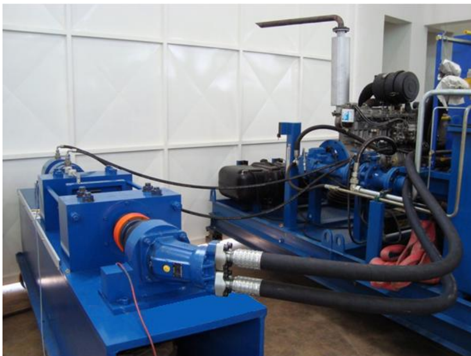
Figura 3. 5 – Posicionamento das mangueiras das mangueiras de alta pressão conectadas ao motor e ao cilindro hidráulico (MAREGA, 2011)
