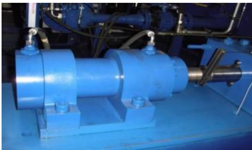
Figura 3. 2 – Cilindro hidráulico responsável pela aplicação da força axial
