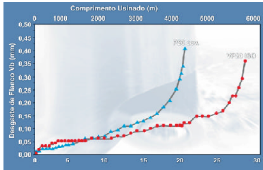
Figura 2.6 - Desgaste de flanco em função do tempo e do comprimento usinado para o P20 e VP20, no fresamento com V_c = 208 m/min, a_p = 2,07 mm, f_z = 0,09 mm/dente a seco (MESQUITA; BARBOSA, 2003)
