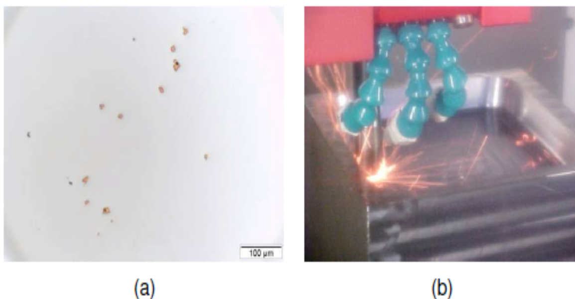
Figura 2.28 - a) Micrografia do aço VP100 com a presença de Carbonitreto de Titânio b) Faiscamento durante o fresamento do aço VP100 (ZANATTA et al., 2009)
