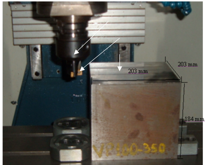
Figura 3.3 - Bloco de VP100 com 350 ppm de titânio, utilizados nos ensaios de fresamento
