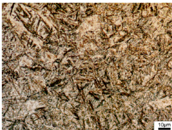
Figura 2.41 – Micrografia óptica do Impax HH mostrando uma fina estrutura contendo martensita com a presença de alguma bainita (HOSEINY et al. ,2011)
