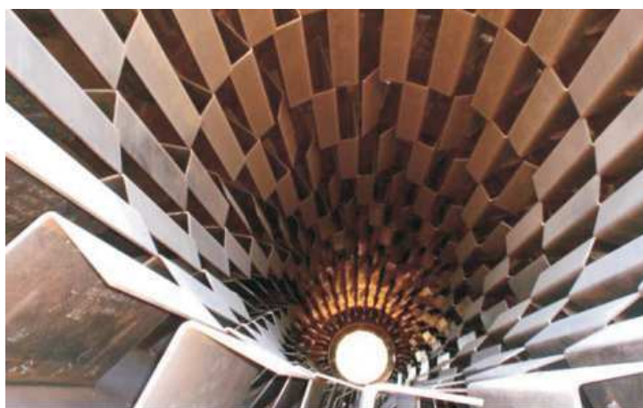
Figura 2.6 – Fotos dos suspensores na parte interna de um secador rotatório industrial (Fonte: Catálogo da empresa DEDINI).
