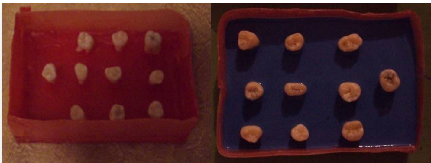
Figura 1: Fixação dos dentes pela raiz em placa de cera rosa 7, confecção de barreira na altura da superfície oclusal e versão de silicone até o limite de 2mm abaixo da junção cimento-esmalte.
