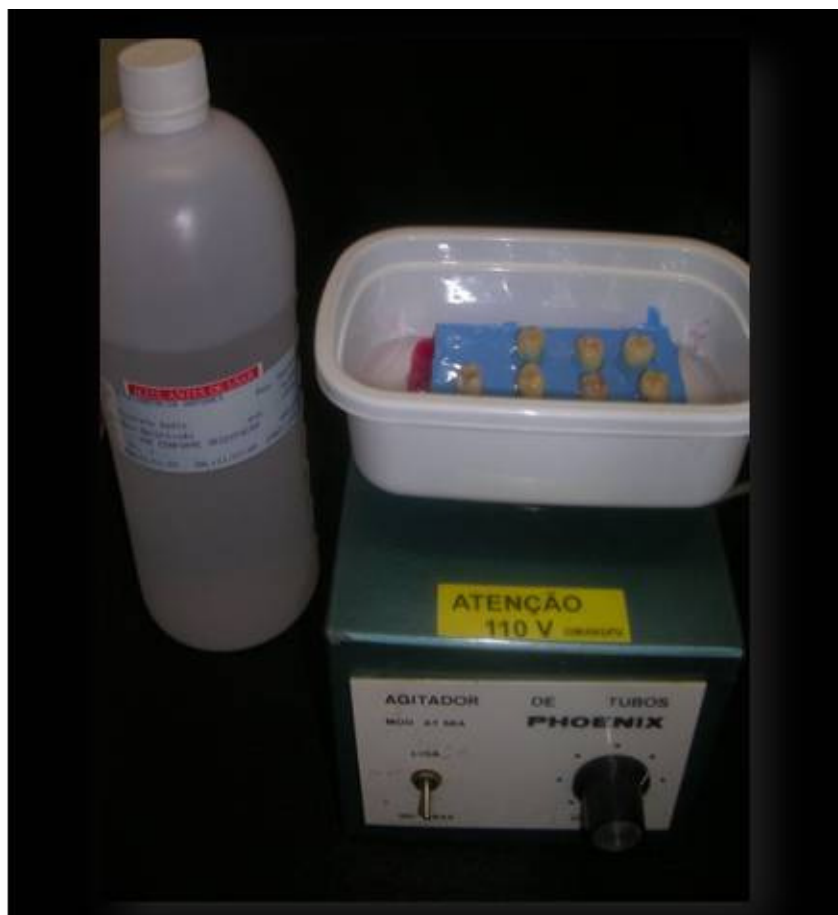
Figura 3: Simulação de bochecho com fluoreto de sódio 0,5% e clorexidina 0,12% em agitador mecânico de laboratório.
