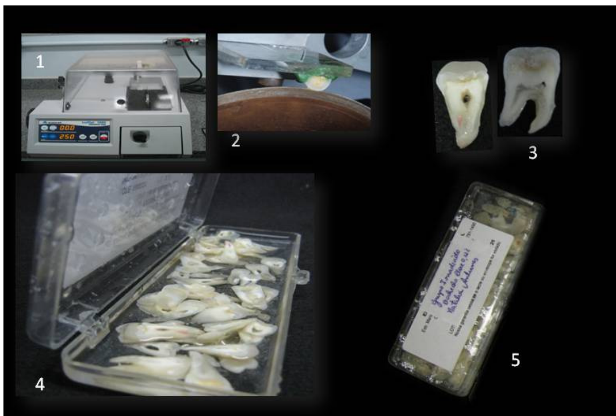
Figura 4: 1- Cortadeira Isomet 1000, 2- Fixação da amostra em placa de acrílico com godiva, 3- Fatias de 1mm de espessura, 4- Armazenamento em água destilada, 5- Identificação dos grupos
