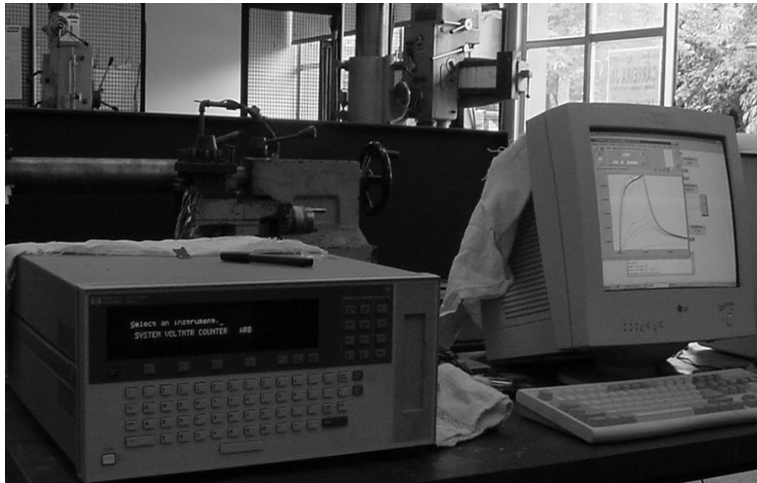
Figura 7.1 – a) Sistema de aquisição (HP) e micro computador; b) Termopares tipo K fixados ao conjunto ferramenta, calço e porta-ferramenta.
