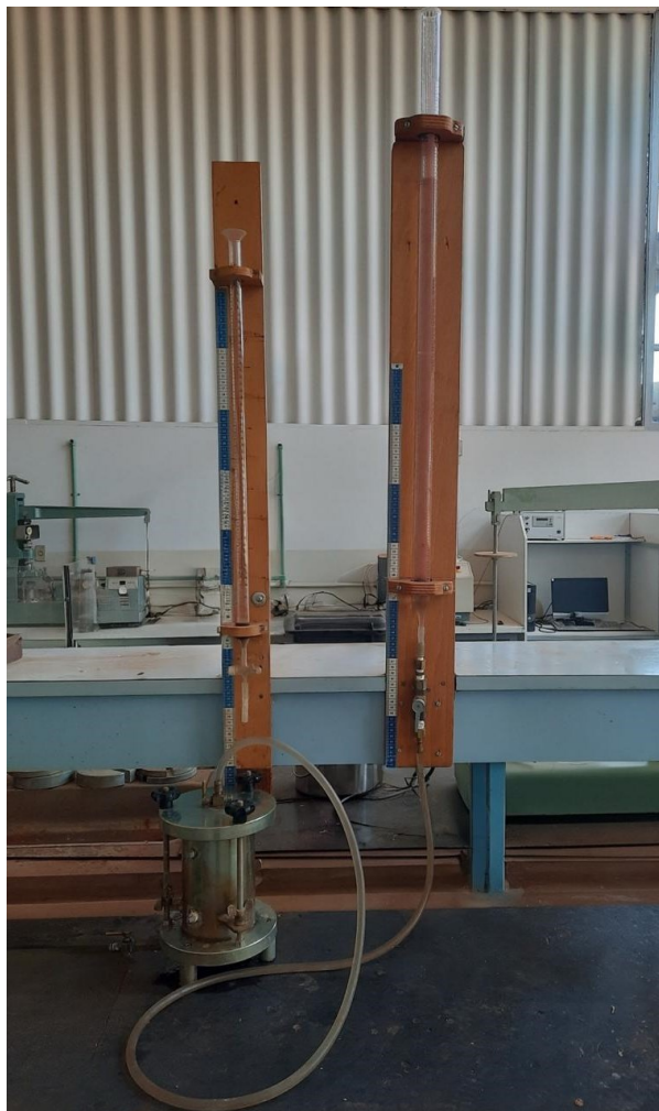
Figura 5 – Permeâmetro e buretas usadas nos ensaios.
