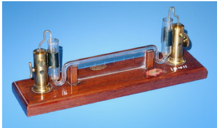
Figura 1.2 – Galvanômetro capilar de Lippmann utilizado por Waller em 1887, para registrar o primeiro eletrocardiograma humano [BINTZ, Jacques; et al. 1997. 1].
