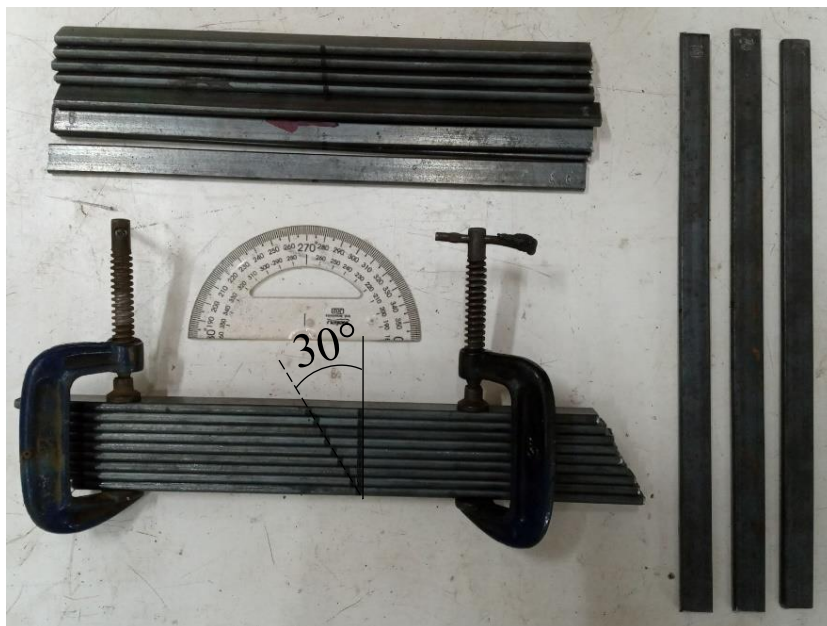
Figura 10 – Marcação do corte com um ângulo de 30°
