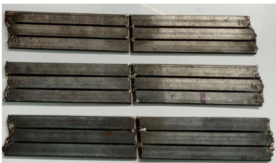
Figura 13 – Três grupos de peças de teste para soldagem com “sobremetal”, com “falta de enchimento” e “sem reforço”
