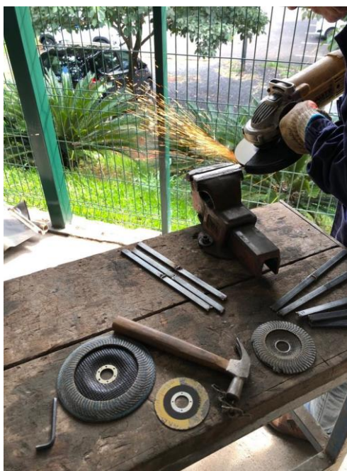
Figura 17 - Esmerilhamento das peças de teste
