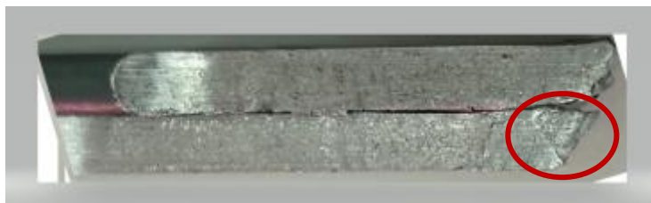
Figura 22- Fratura da ZAC para metal de base (corpo de prova 17)
