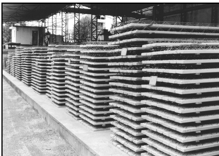
Figura 3.13 - Armazenamento das vigotas [PUMA (2002)].
