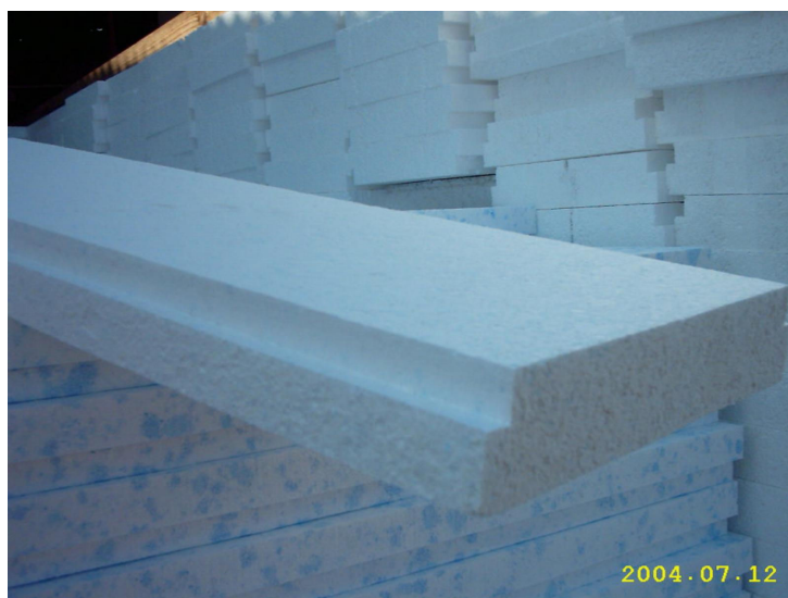
Figura 2.2 - Lajota de EPS [SÍTIO LAJEPOR - Acesso: em 17 jun. 2005].
