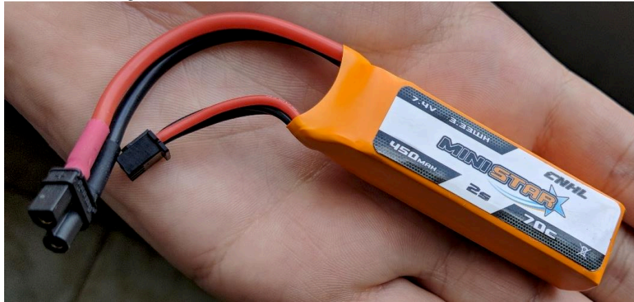
Figura 19: Bateria CNHL de 7.4 V, 2S, 450 mAh e 70 C.
