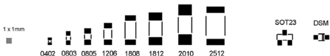
Figura 58: Encapsulamentos SMD: componentes passivos 0402 - 2512, SOT23 para transistor e DSM para diodo.
