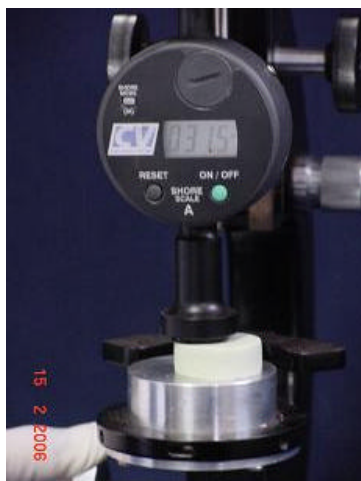
Figura 4.2.1.5 - Durômetro shore A (Shore Scale Durometer Hardness Tester, England) utilizado na mensuração da dureza do cilindro do simulador de alimento “Optocal”
