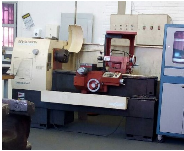
Figura 10. Torno Revolution RV 220 com Dinamômetro plataforma piezoelétrica Kistler.
