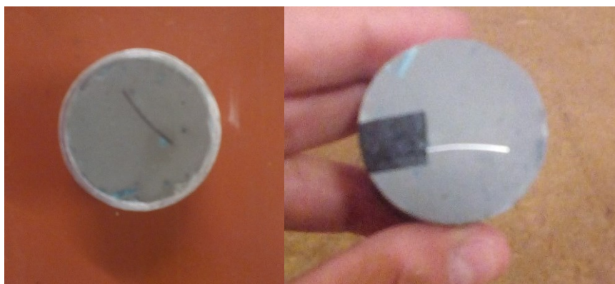
Figura 26. Amostra de cavaco embutida (ferramenta sem revestimento com velocidade de corte 60 m/min).
