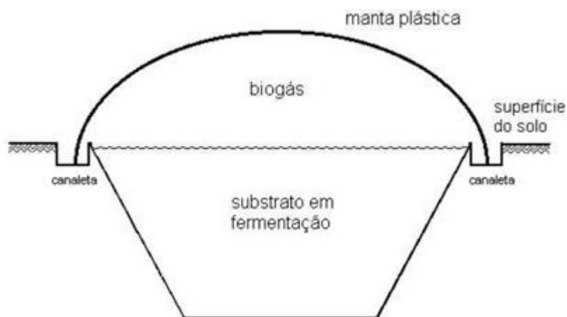
Figura 8: Biodigestor Batelada Tubular com manta plástica.
