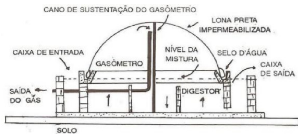
Figura 7: Biodigestor modelo Canadense.
