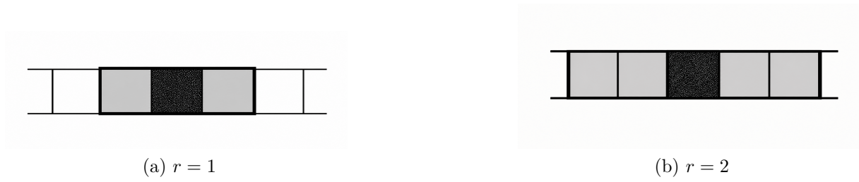
Figura 3 – Vizinhanças de um AC unidimensional. A região em preto indica a célula central que é atualizada de acordo com o estado das células em cinza.
