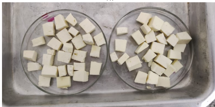
Figura 29 - Aspecto das amostras de muçarela após secagem em liofilizador por 48 h.
