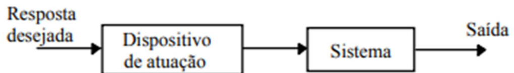
Figura 2.6 - Diagrama de Blocos Malha Aberta
