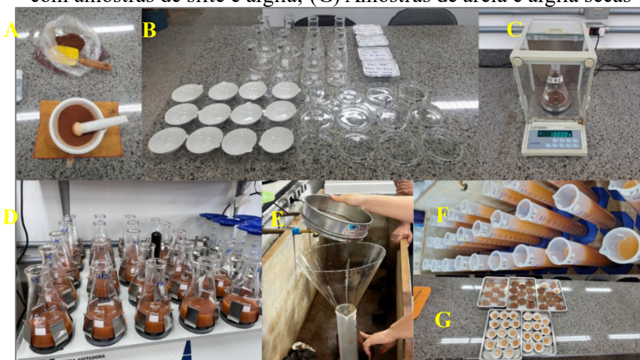
Figura 6 – Etapas análise granulométrica: (A) Destorroamento; (B) Separação das vidrarias; (C) Pesagem das amostras; (D) Agitação das amostras; (E) Separação da areia; (F) Provetas com amostras de silte e argila; (G) Amostras de areia e argila secas
