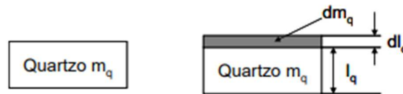
Figura 4 - Esquemático representativo da deposição de uma variação de massa na superfície do cristal de quartzo.
