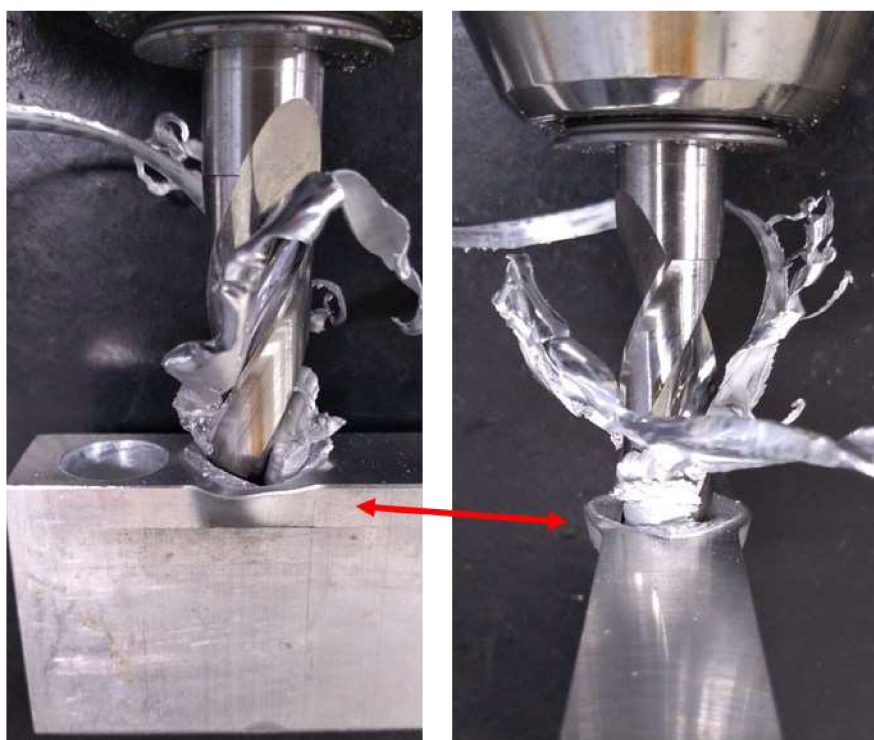
Figura 8 Demonstração real da deformação plástica localizada em um corpo de prova durante o ensaio de furação a seco com broca helicoidal de aço-rápido
