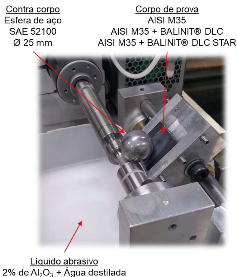
Figura 25 Ilustração do equipamento e dos principais componentes utilizados para a realização do ensaio de desgaste microabrasivo
