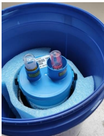
Figura 6: Gerador de molibdênio-99/tecnécio-99m acondicionado em blindagem de chumbo, com frascos de cloreto de sódio 0,9% e coletor a vácuo posicionados nas extremidades do sistema de eluição.
