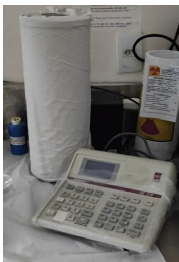
Figura 9: Curiômetro (medidor de atividade) modelo CRC-15W, utilizado para aferição da atividade dos radiofármacos na radiofarmácia.
