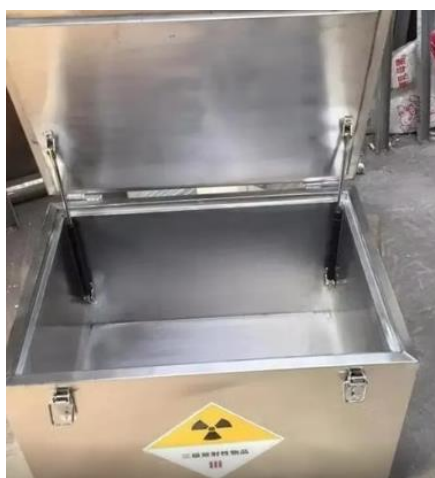
Figura 10: Depósito de decaimento blindado com chumbo, utilizado para o armazenamento de rejeitos radioativos até que sua atividade atinja níveis seguros para descarte.
