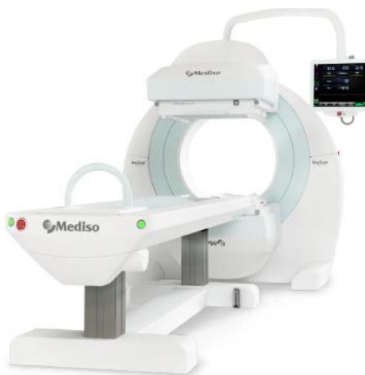
Figura 4: Equipamento de Gama Câmara, evidenciando os cabeçotes detectores acoplados ao gantry , responsáveis pela captação da radiação gama, e a mesa de exame utilizada para o posicionamento do paciente durante a aquisição das imagens.
