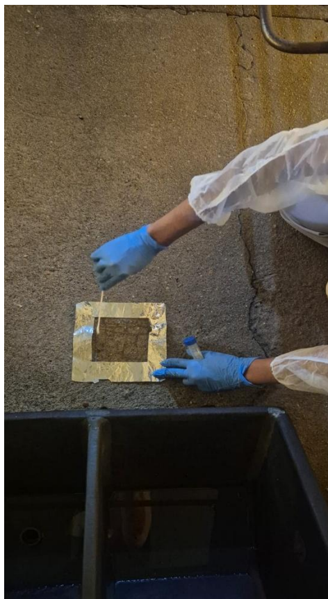
Figura 7: Método didático de como foi executada a coleta do material feito com suabe
