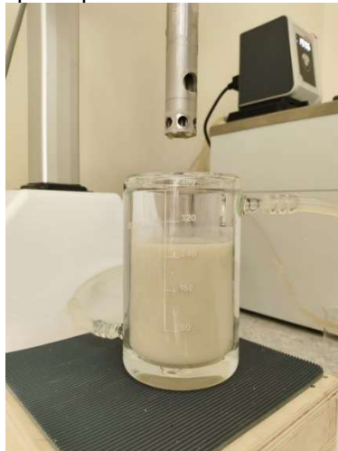
Figura 8 - Fluido aquoso polimérico saturado no reator encamisado.
