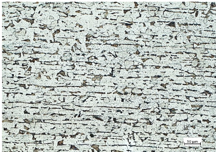
Figura 4.4 – Microestrutura do substrato de aço carbono, evidenciando bandejamento típico de material laminado.
