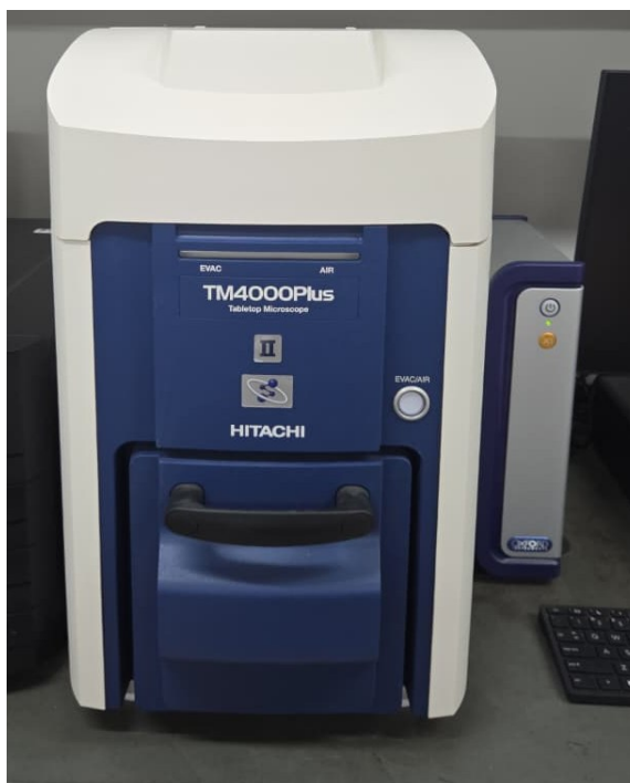
Figura 3.4 - Microscópio eletrônico de varredura Hitachi TM4000Plus com sistema de microanálise por EDS acoplado.
