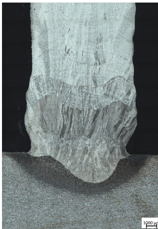
Figura 4.1 – Macrografia da seção transversal da preforma de ER308LSi depositada sobre substrato de aço carbono, evidenciando os cordões sucessivos e as linhas de fusão.
