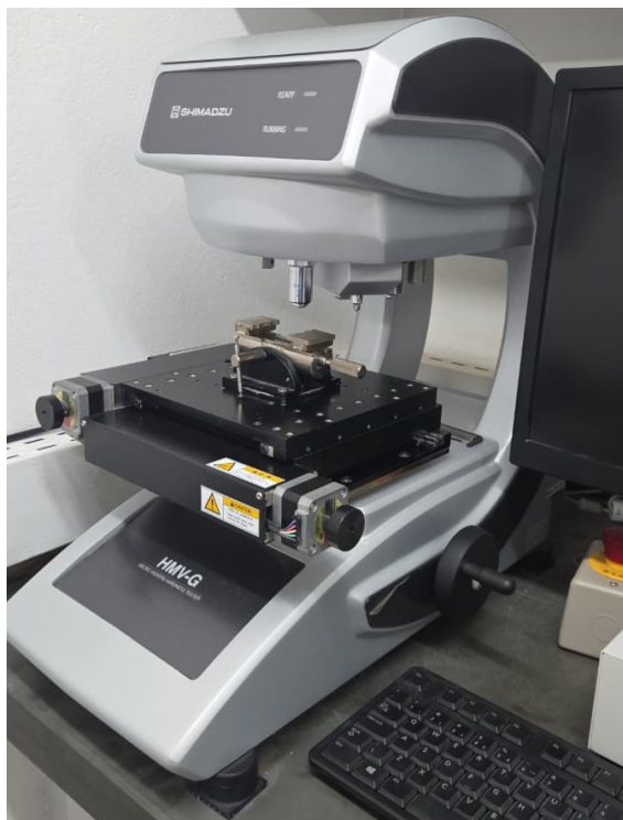
Figura 3.5 - Microdurômetro Shimadzu HMV-G utilizado no levantamento do perfil de microdureza Vickers.
