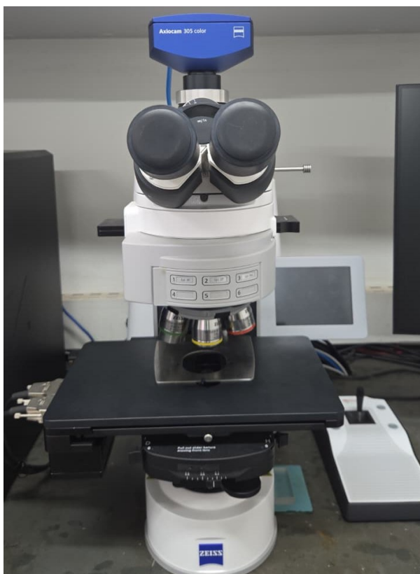
Figura 3.3 - Microscópio óptico Zeiss utilizado na caracterização microestrutural.
