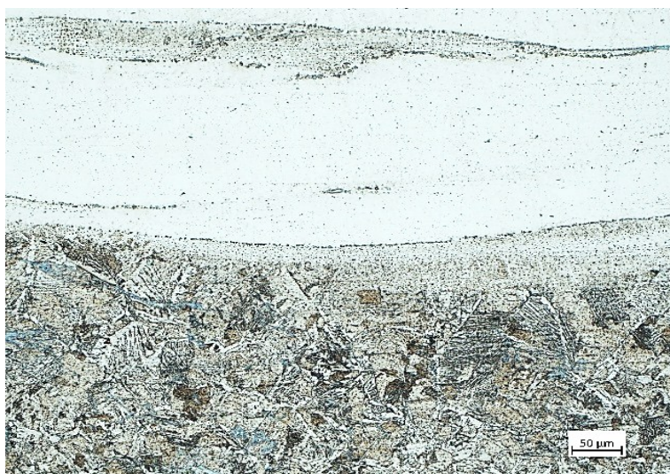
Figura 4.8 – Região de interface, evidenciando a transição entre regiões de morfologia distinta.
