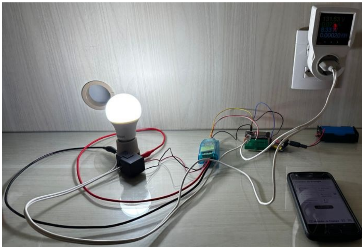
Figura 29 — Análise simultânea do medidor S1 e do protótipo deste projeto, utilizando o PZEM-004T.
