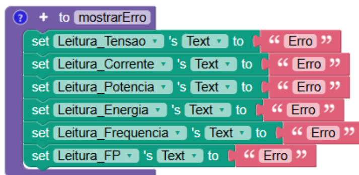
Figura 25 — Função que define os valores das leituras como "Erro" em caso de falha na leitura dos dados do módulo PZEM.
