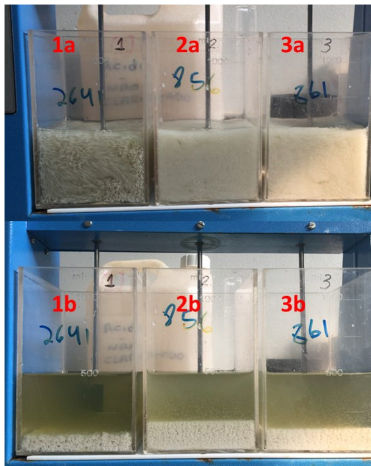
Figura 4.37: Seleção e testes de flocculantes: 1 - polímero aniônico de alta carga, 2 - polímero aniônico de baixa carga; 3 - polímero aniônico de média carga; a – após dosagem do polímero; b – após 60 s de adição
