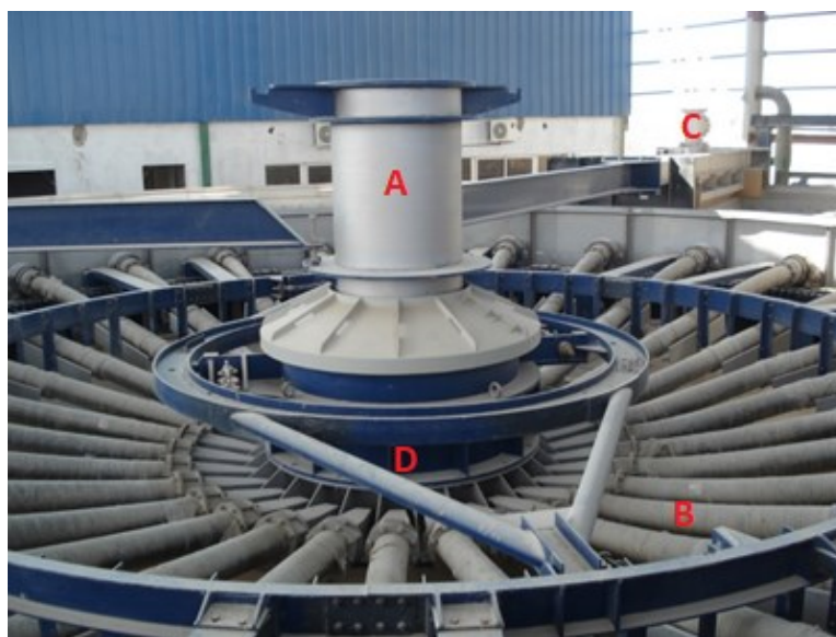
Figura 2.23: Filtro com secção de geração de vácuo, em montagem, onde A é o ponto de conexão ao sistema de vácuo da unidade, B são os mangotes, individuais para cada bandeja do filtro, onde coleta-se as correntes de ácido, C o duto onde alimenta-se a corrente para a primeira lavagem da torta, e D a caixa de vácuo, onde partições internas separam os fluxos de ácido não clarificado, ácido de reciclo e ácido fraco (do autor)
