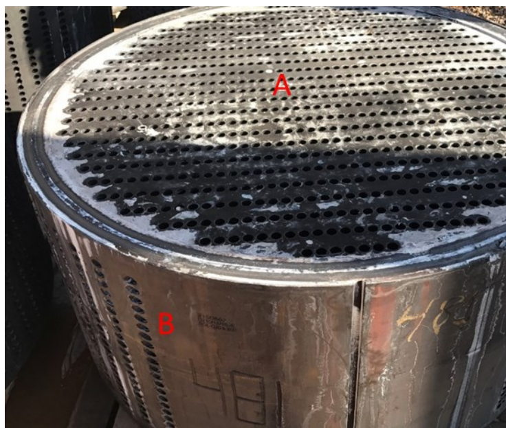
Figura 2.27: Bloco de grafite para aquecimento do ácido fosfórico através da condensação de vapor saturado, onde os dutos verticais apresentam fluxo ascendente de ácido fosfórico (A) e dutos horizontais apresentam fluxo de vapor e condensado (B) (do autor)
