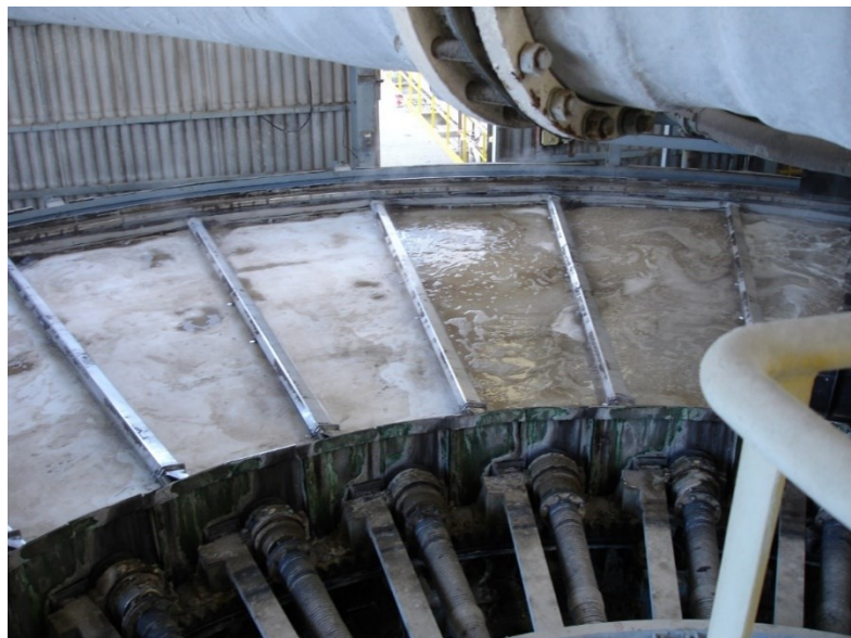
Figura 2.22: Filtro em operação, após primeira lavagem da torta, com geração da corrente de ácido de reciclo (do autor)
