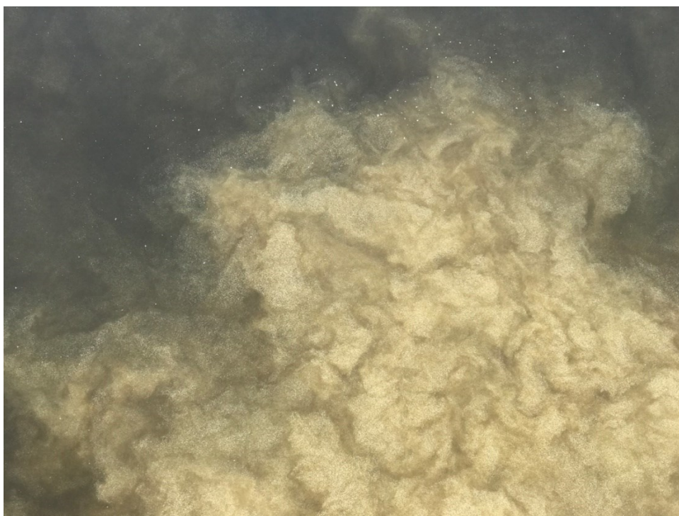
Figura 4.56: Floculação dos fosfonatos de ferro no decantador
