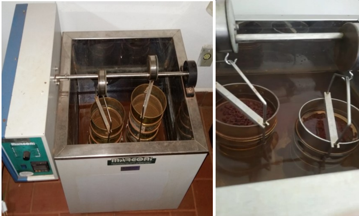
Figura 6 – Aparelho de Yooder de oscilação vertical para determinação de estabilidade de agregados, em peneiras com malha de 2,0; 1,0; 0,5; 0,25 e 0,106 mm
