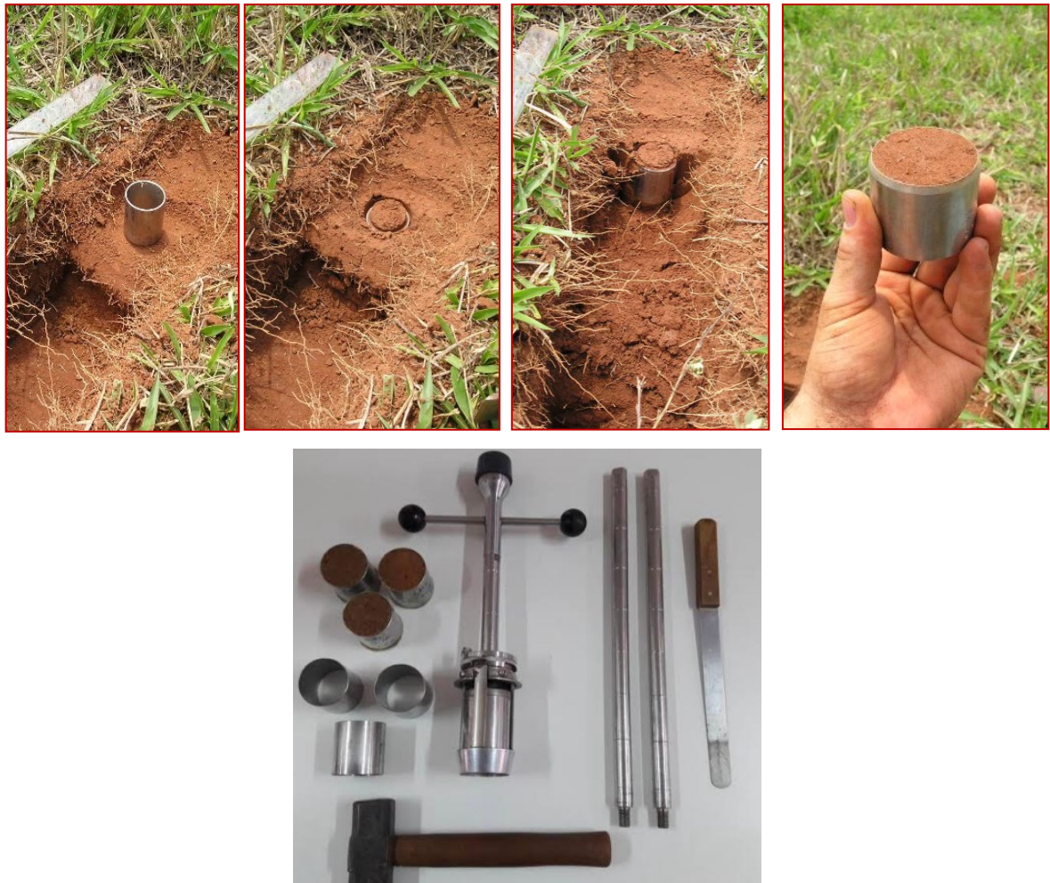
Figura 4 – O anel volumétrico de aço foi cravado no solo de 0 a 0,10 e 0,10 a 0,20 m de profundidade com o trado de Uhland, para coleta de amostra de solo indeformada, em Uberaba, MG, 2024.
