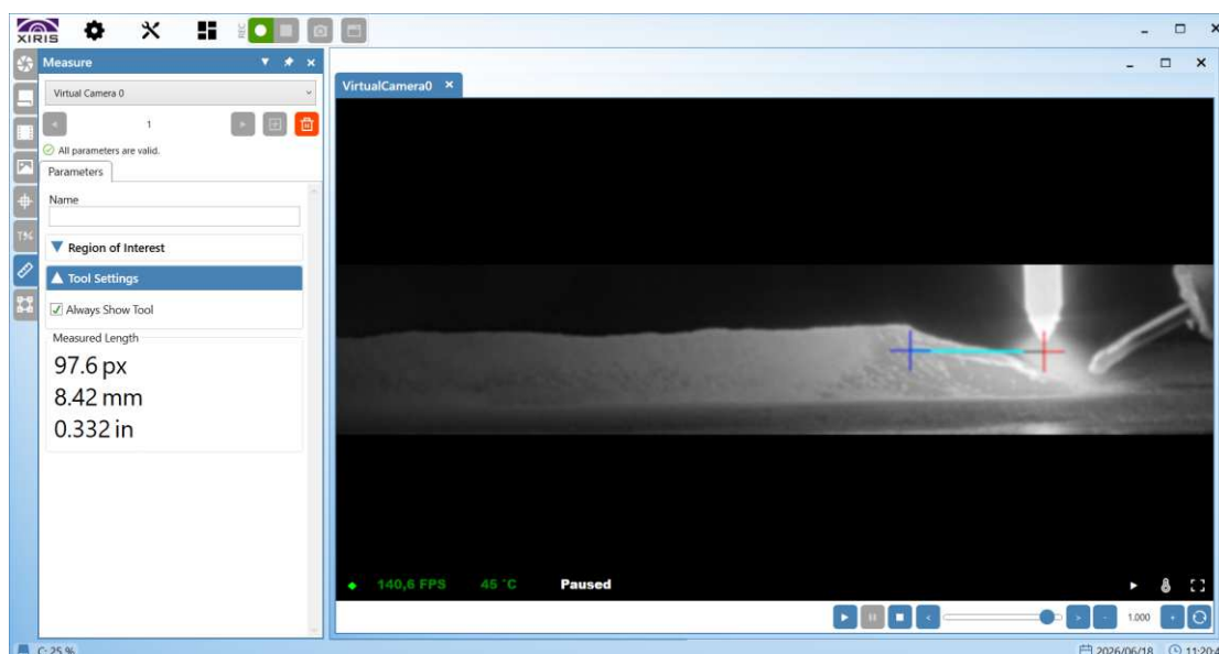
Figura 7.10 - Ferramenta Measure do software WeldStudio Pro: medição de comprimento da poça de fusão com calibração pelo diâmetro do eletrodo de tungstênio.
