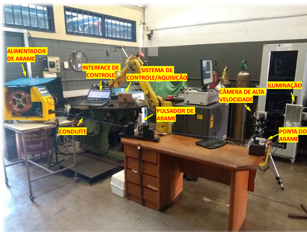
Figura 4.6 - Bancada experimental utilizada nos ensaios de avaliação do dispositivo pulsador de arame
