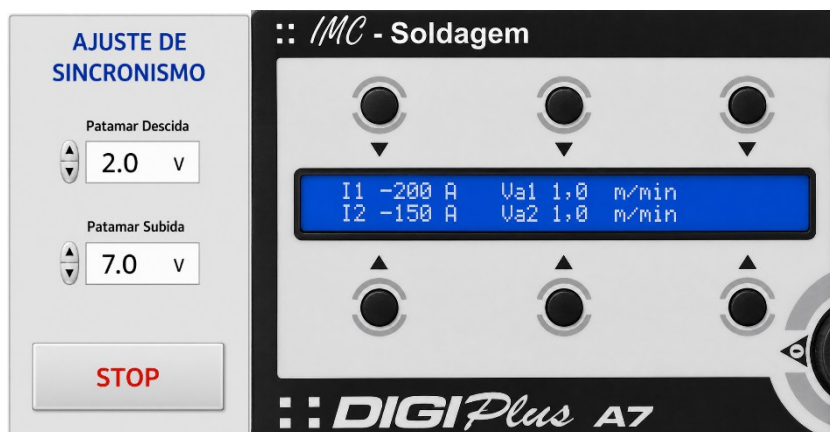
Figura 6.3 - (Esq.) Tela de controle dos níveis de tensão - Versão 1 (Dir.) Interface de ajuste dos parâmetros I1 e I2 no menu TIG SINCRO da fonte de soldagem.
