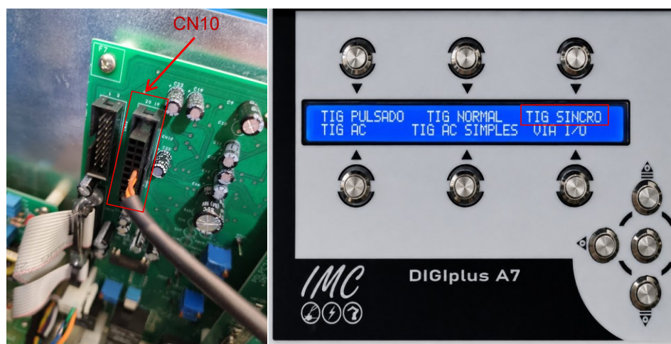
Figura 6.2 - (Esq.) Conector CN10 da fonte de soldagem (Dir.) modo operacional TIG SINCRO.
