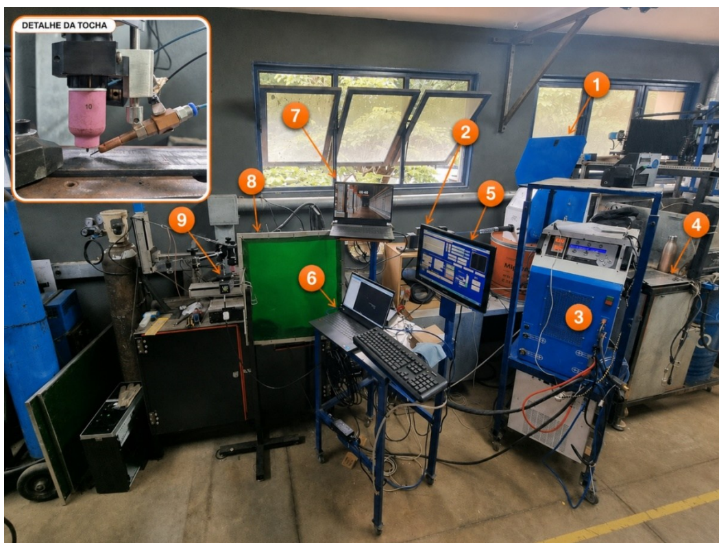
Figura 7.1 - Bancada experimental utilizada, composta por alimentador de arame (1), pulsador de arame (2), fonte de soldagem IMC modelo DIGIPlus A7 (3), sistema de aquisição de dados (4), sistema de controle da mesa XYZ (5), software da câmera Tardis longo WPM (6), software da câmera Xiris WeldStudio Pro (7), câmera Tardis IGNIS MP200GS (8 – posicionada atrás do biombo) e câmera Xiris XIR-1800 (9). O detalhe apresenta a configuração da tocha TIG e do sistema de alimentação de arame utilizado.
