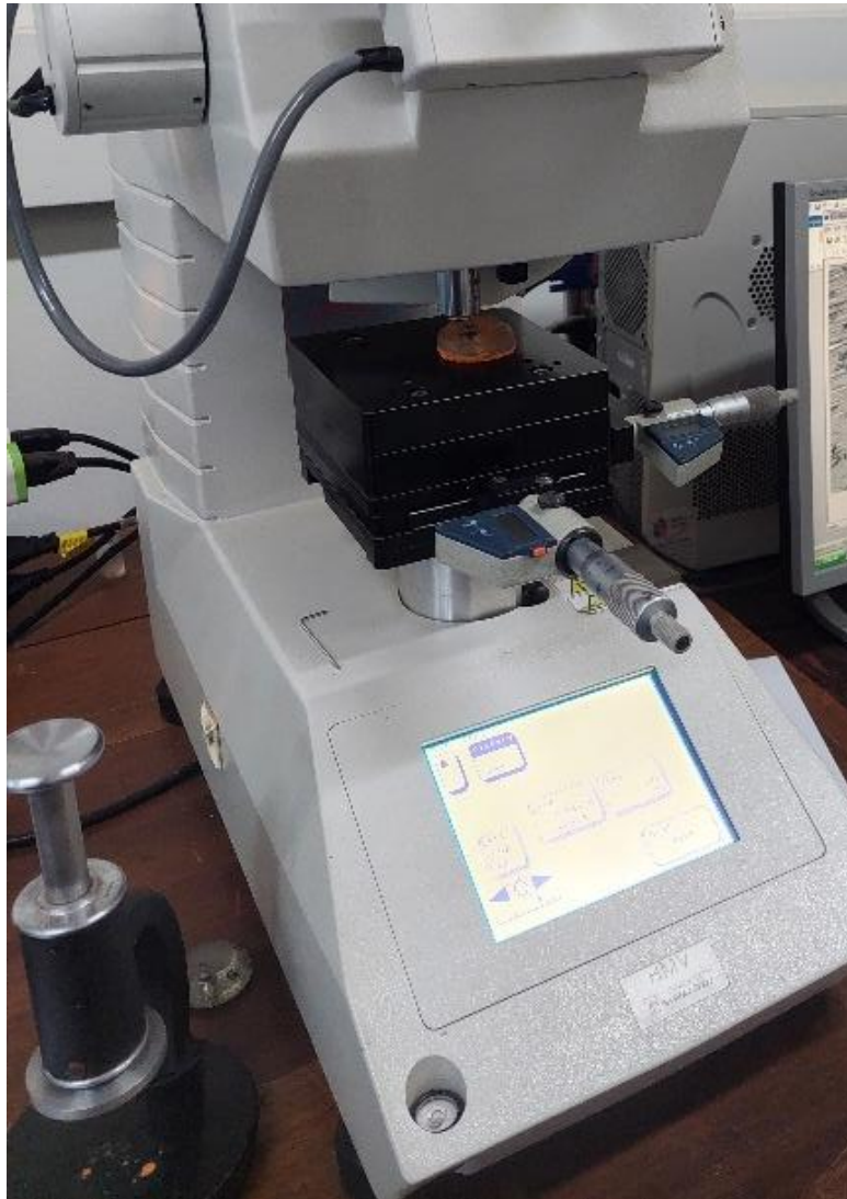
Figura 20 – Ensaio de microdureza Vickers utilizando o Shimadzu HMV-2, para uma amostra de cavaco. A amostra de cavaco encontra-se em um corpo de resina, a qual permite que o indentador penetre na região lateral do cavaco.
