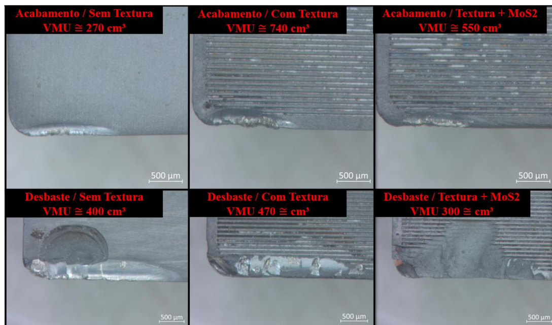
Figura 55 – Imagem obtida por microscopia óptica da superfície de saída da ferramenta de corte após a limpeza química com reagente de Kroll, evidenciando a remoção do material aderido e permitindo a identificação das regiões efetivamente desgastadas da ferramenta.
