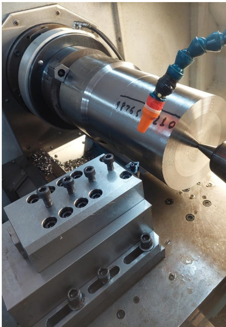
Figura 17 – Dinamômetro Kistler 9265B contendo o suporte que por sua vez contém a ferramenta de corte, para o torneamento da barra de Ti6Al4V. Também é possível ver a mangueira do fluido de corte, o qual jorrou o fluido Vasco7000 durante todo o torneamento, e as marcações na barra para diferentes testes.
