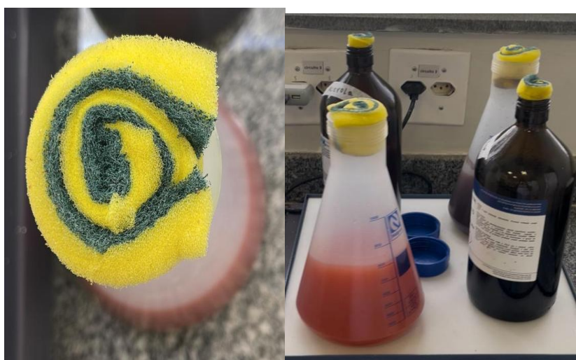
(Figura 11: material poroso utilizado como fechamento nos Erlenmeyers)
