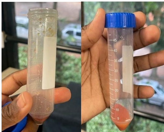
(Figura 7: Resíduos lipídicos aderidos à parede do tubo após centrifugação da bebida fermentada de açai(esquerda) e de acerola (direita).)
