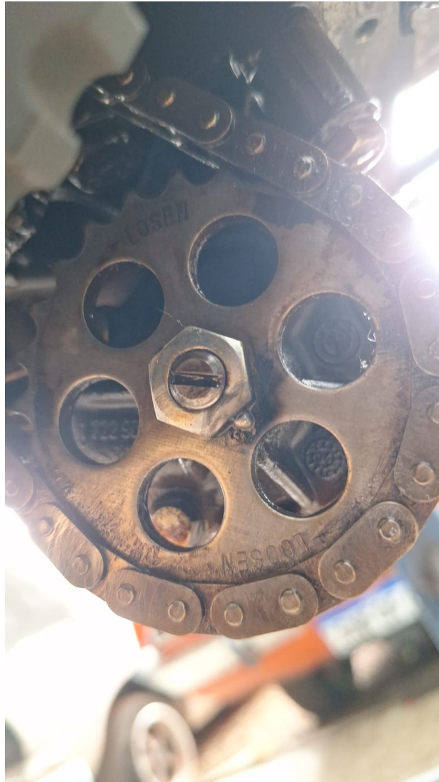
Figura 26 – porca da bomba de óleo soldada
