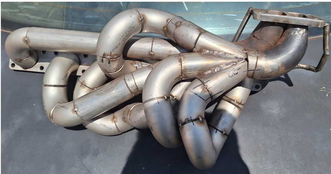
Figura 36 – coletor de exaustão fora do carro
