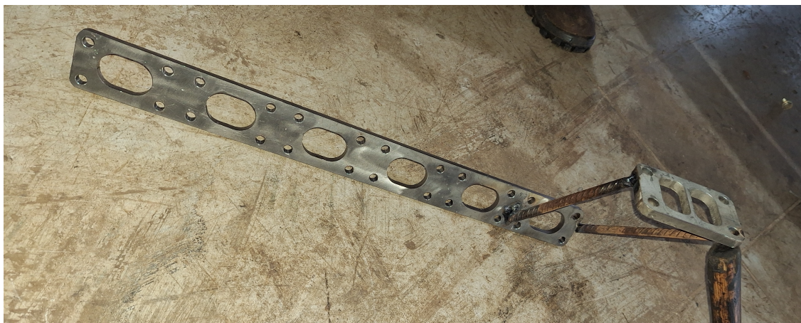
Figura 32 – barra de aço unindo as duas flanges
