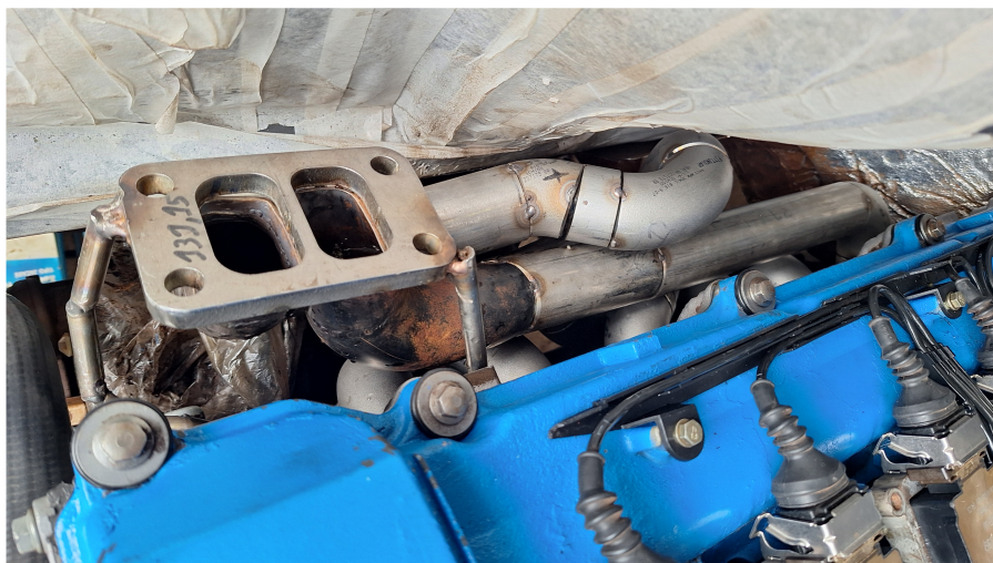
Figura 34 – coletor de exaustão sendo testado no carro
