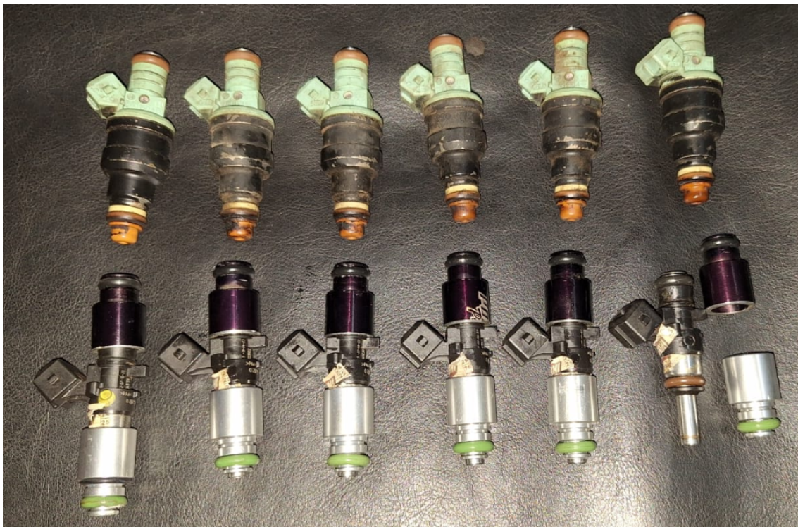
Figura 25 – bicos injetores originais e seus substitutos
