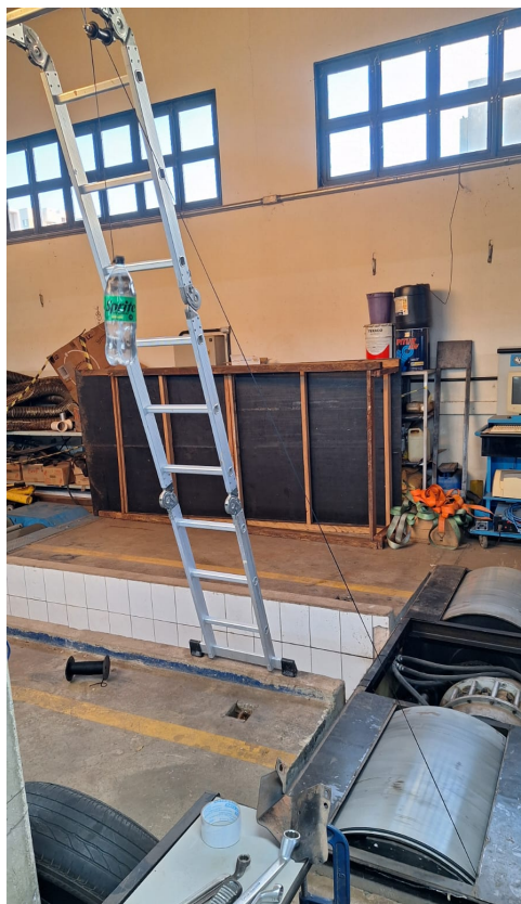
Figura 21 – Medição do momento de inércia do rolo
