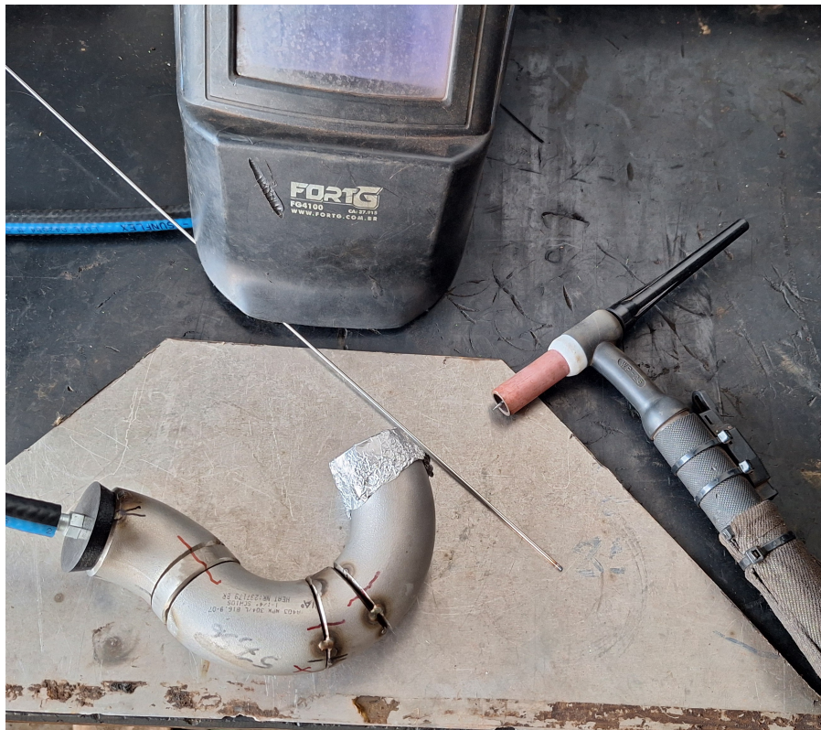
Figura 29 – soldagem do coletor de exaustão
