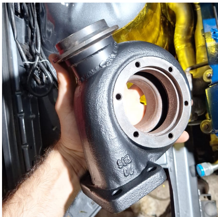
Figura 40 – flange da wastegate soldada à carcaça da turbina
