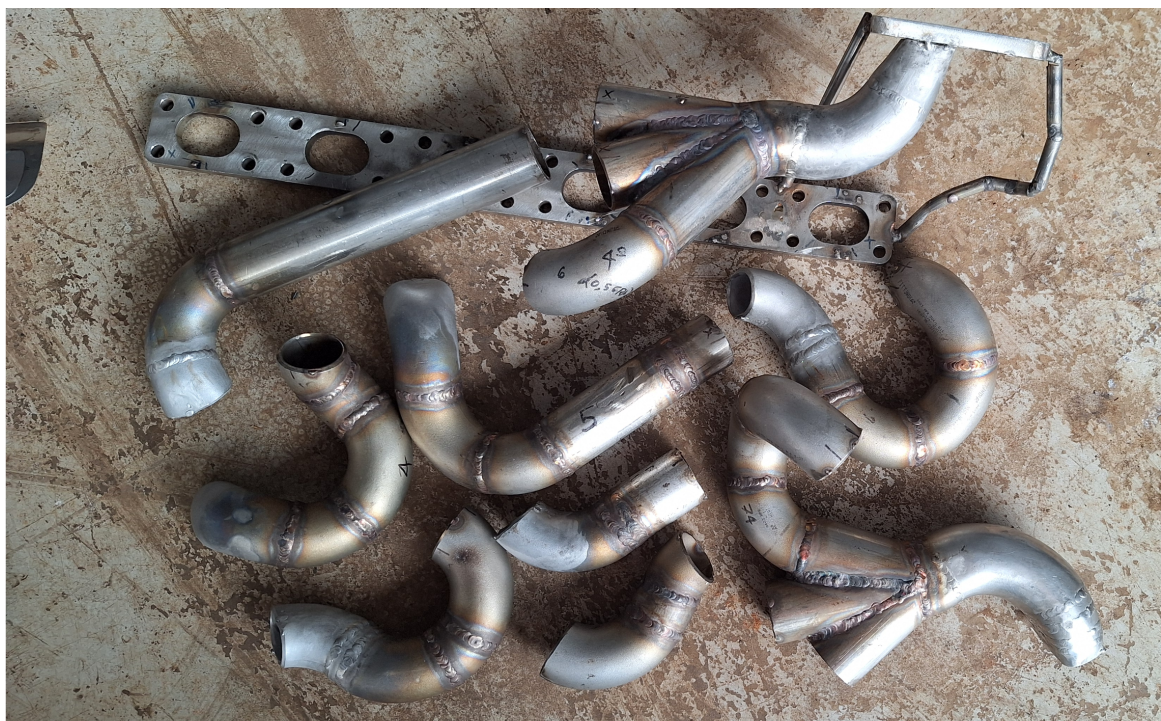
Figura 37 – coletor desmontado durante soldagem
