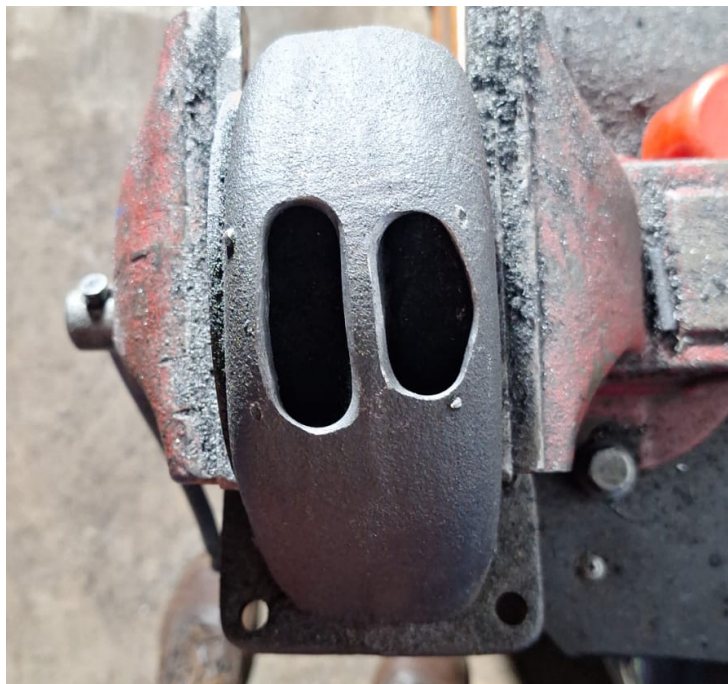
Figura 39 – furo na carcaça da turbina para adaptação de wastegate
