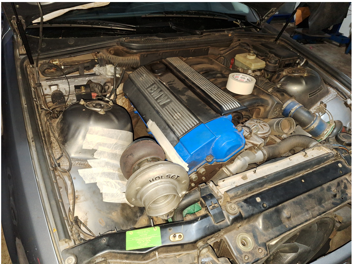
Figura 30 – turbocompressor posicionado manualmente
