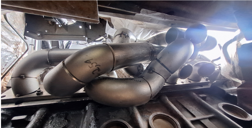
Figura 35 - coletor de exaustão sendo testado no carro
