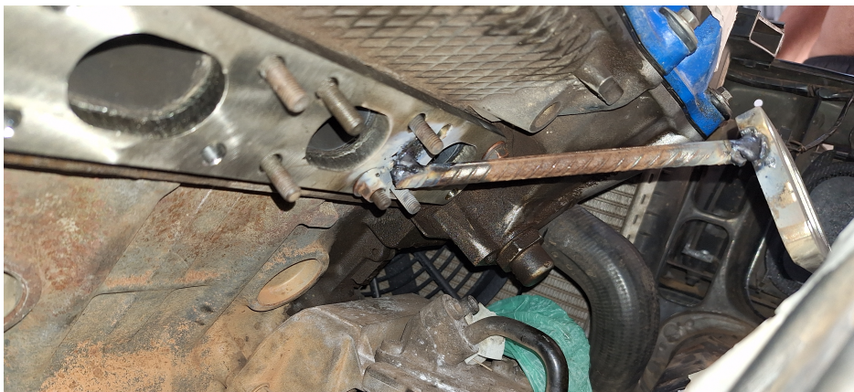
Figura 31 – barra de aço unindo as duas flanges
