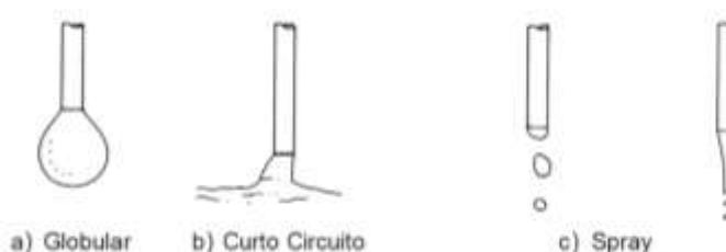
Figura 2.6 - Modos de transferência metálica no processo GMAW (Modenesi, 2008).
