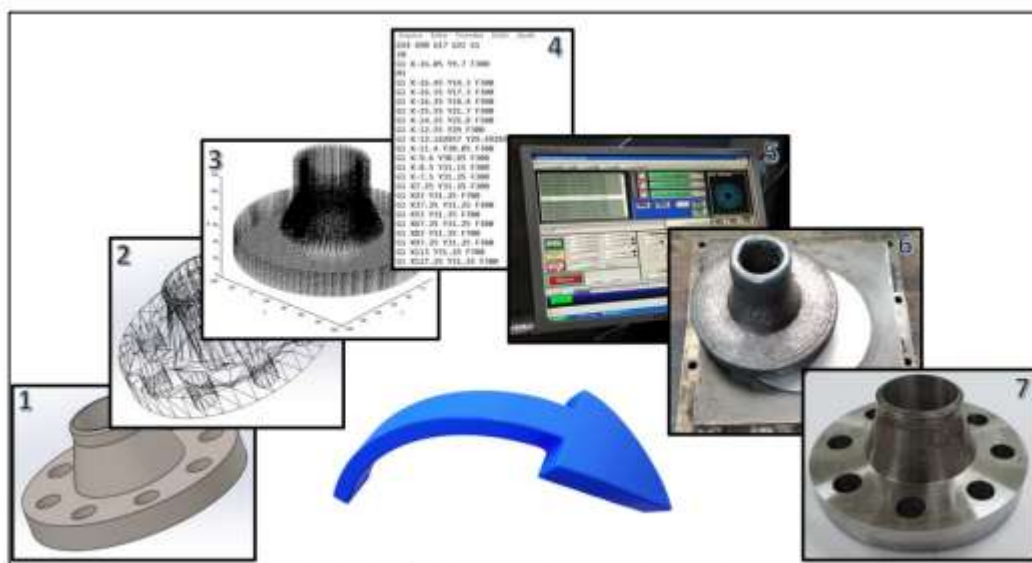
Figura 2.3 - Etapas sequenciais de fabricação de um flange: 1) Modelagem 3D e definição do produto; 2) Geração do arquivo STL; 3) Planejamento da trajetória de deposição; 4) Composição da linguagem de programação; 5) Deposição; 6) Pós processamentos; 7) Acabamento e inspeção (Ferraresi, 2023, adaptado).
