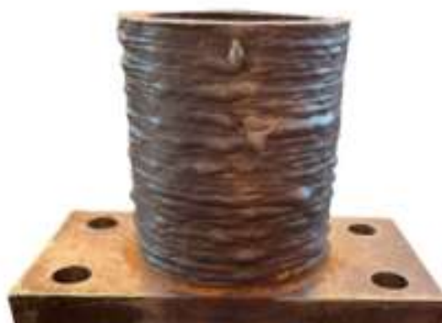
a) Amostra B, material feito por deposição convencional de MA seguido de tratamento por vibração para alívio de tensões residuais após a MA.
