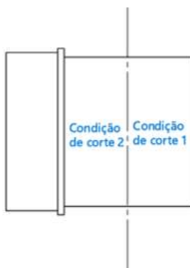
Figura 3.10 - Ilustração da divisão de regiões ao longo do comprimento da peça nas amostras para a realização dos ensaios de torneamento.
