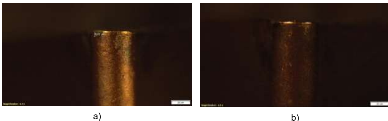
Figura 4.13 - Ponta das ferramentas após a usinagem: a) V_c = 140 m/min, amostra I teste 2 sem alívio de tensões após deposição e L_c = 45 mm; b) V_c = 140 m/min, amostra II teste 4, com alívio de tensões após deposição e L_c = 45 mm.
