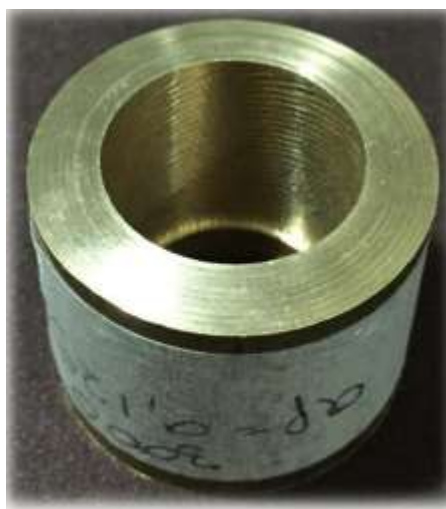
Figura 2.17 - Acabamento superficial na usinagem interna a 3000 rpm e a_p=0,125 mm apresentando vibrações durante o processo (Cabau; Cossich, 2015, adaptado).
