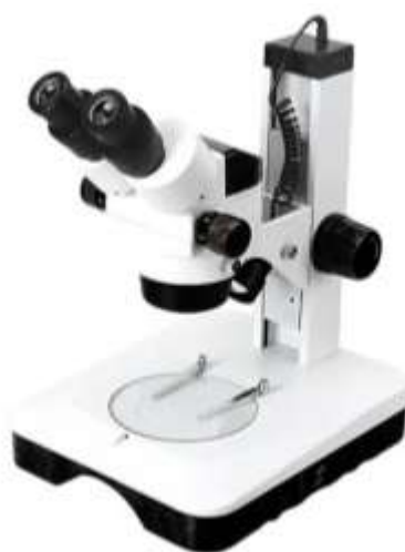
Figura 3.14 - Microscópio Olympus SZ61 utilizado nas medições dos desgastes das ferramentas de corte (Prolab, 2025).
