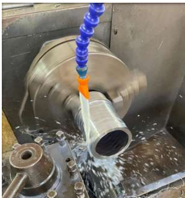
Figura 3.9 - Foto do set-up para torneamento de desbaste das amostras de aço feito por MA.
