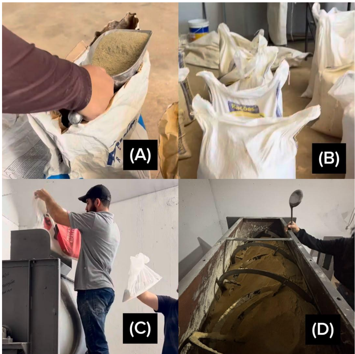
Figura 2. Etapas do preparo da mistura e adição dos ingredientes para a fabricação da ração experimental. (A) Pesagem dos microingredientes; (B) Macroingredientes separados para a mistura da ração; (C) Adição dos ingredientes ao misturador; (D) Momento da coleta para análise
