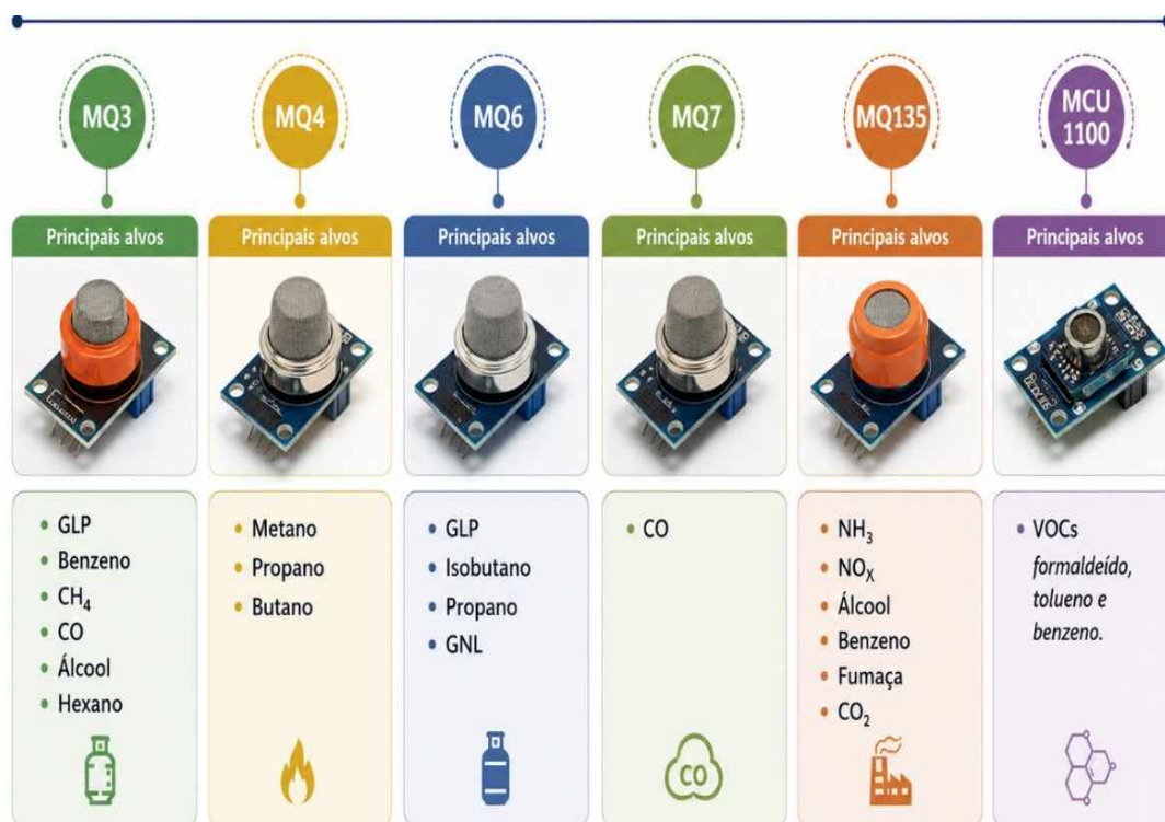
Figura 6 - Arranjo de sensores semicondutores de óxido metálico do sistema e-nose e respectivos analitos-alvo
