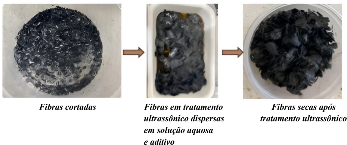
Figura 4.7: Processo de dispersão das fibras de carbono
