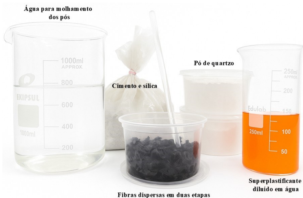
Figura 4.8: Materiais utilizados na preparação das misturas
