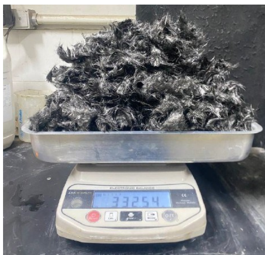
Figura 5.30: Volume de fibras adicionado à mistura EC-3,7%F13-850
