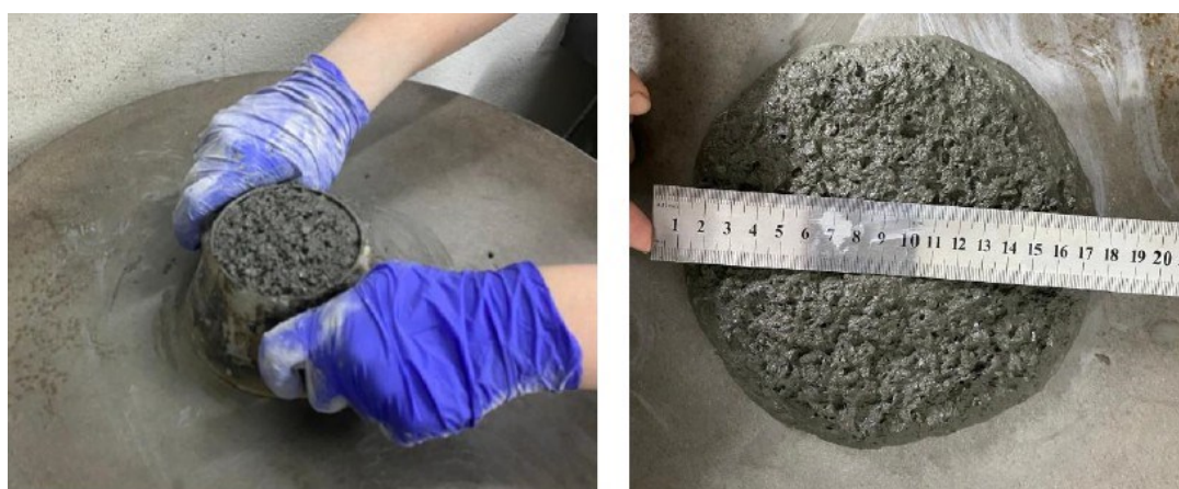
Figura 4.9: Ensaio de índice de consistência
