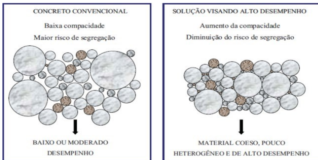
Figura 3.1: Empacotamento granular como solução de dosagem
