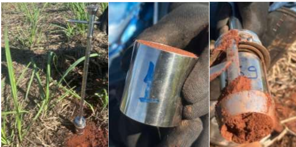
Figura 2 - Anel volumétrico de aço sendo cravado a 10 cm m de profundidade para coleta de amostra de solo indeformada, com o trado de Uhland em Itapagipe, MG, 2025.
