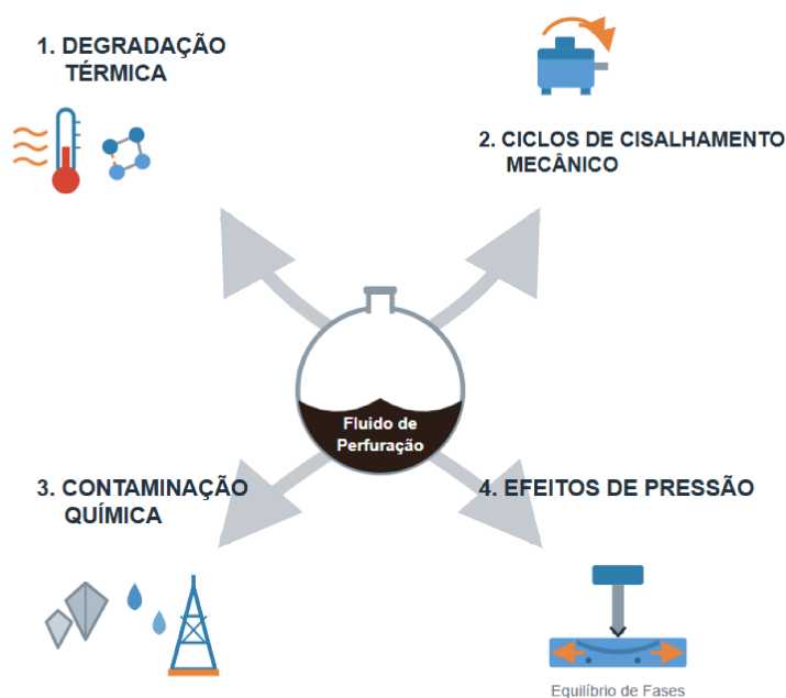
Figura 4 – Representação dos fatores que contribuem para o envelhecimento do fluido de perfuração: degradação térmica, ciclos de cisalhamento, interações químicas com a formação e variações de pressão.
