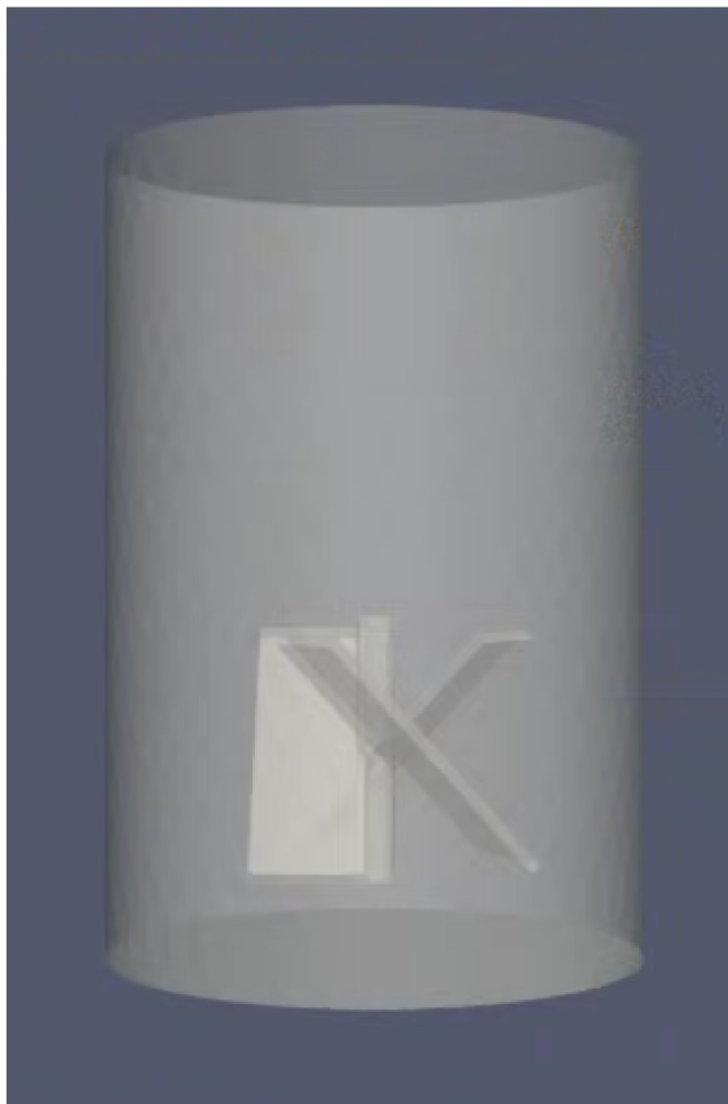
Figura 11 – Geometria da célula de envelhecimento: vaso cilíndrico com o impelidor de pás inclinadas montado centralmente.
