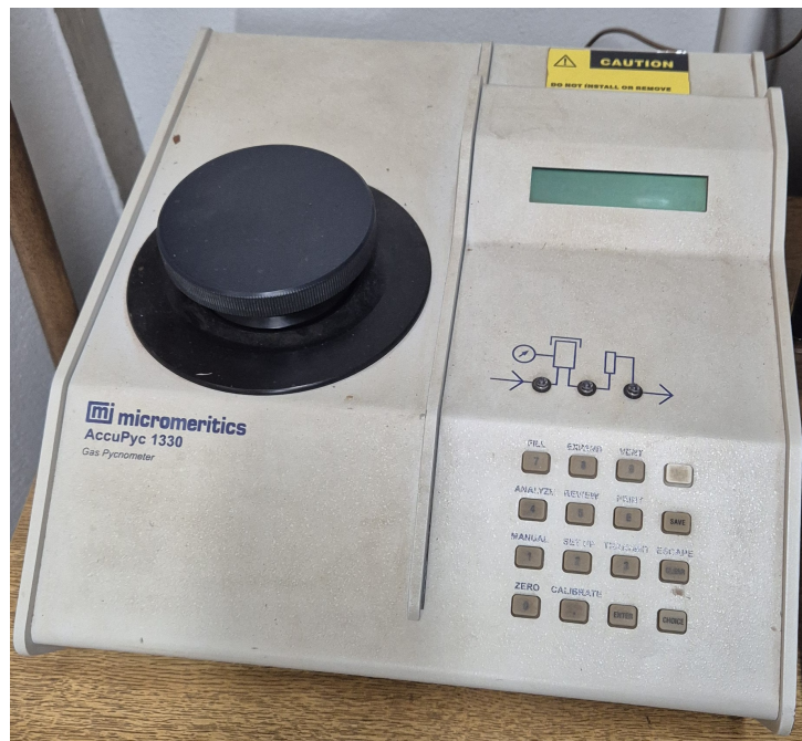
Figura 8 – Picnômetro de gás hélio Micromeritics AccuPyc 1330 utilizado na determinação da massa específica.
