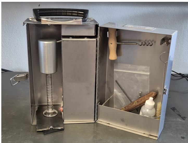
Figura 7 – Conjunto de retorta empregado na determinação do teor de sólidos do fluido de perfuração.
