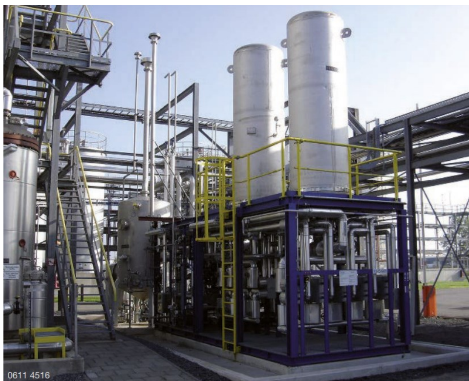
Figura 2- Planta de pervaporação utilizando membranas.
