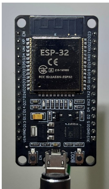
Figura 5 - Placa de Desenvolvimento ESP32 de 30 Pinos
