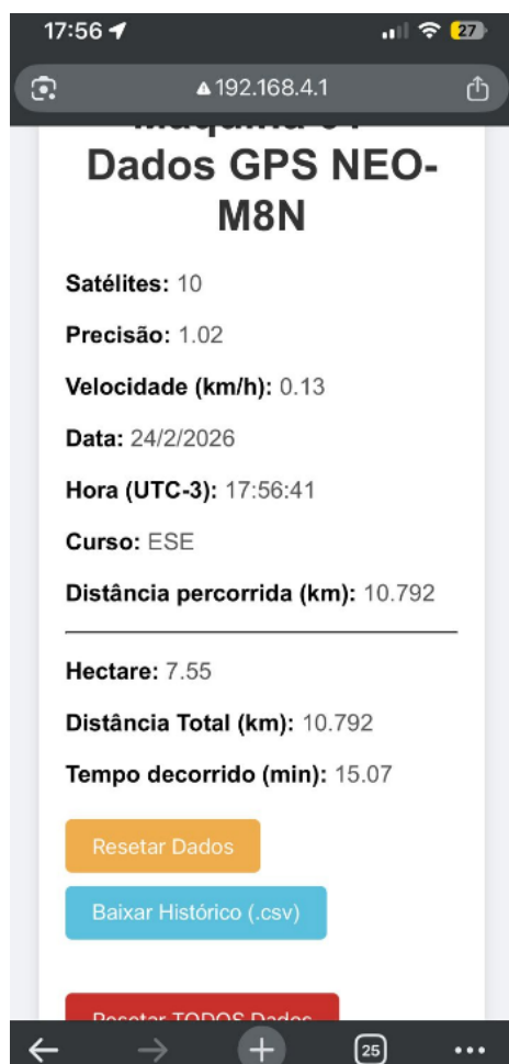
Figura 66 - Dados obtidos e calculados pelo código implementado no ESP32
