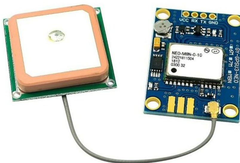
Figura 6 - Módulo GNSS NEO-M8N e Antena
