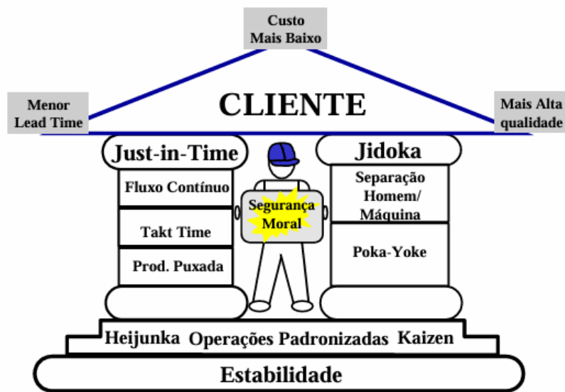
Figura 2 – A Estrutura do Sistema Toyota de Produção
