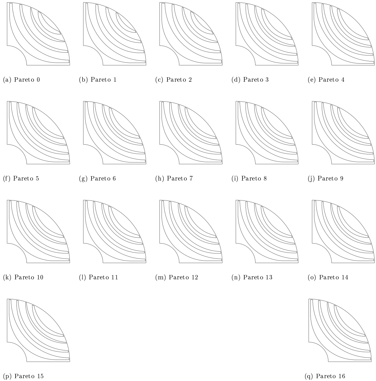
Figura 63 – Geometrias correspondentes às soluções pertencentes à fronteira de Pareto obtida para a topologia Arredondado Modificado.
