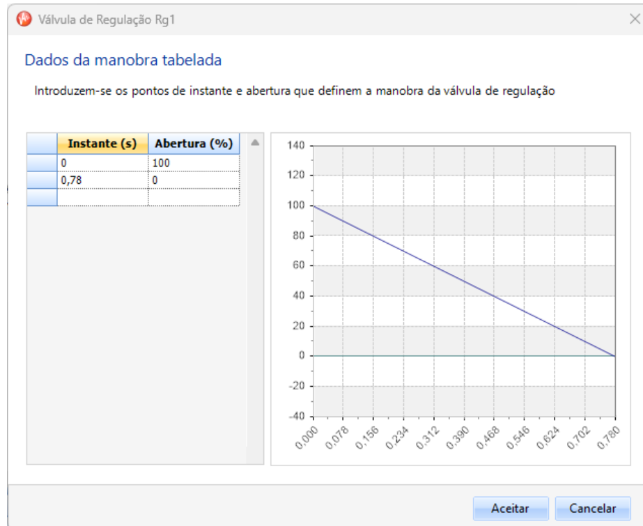
Figura 19: Comportamento do fechamento da válvula no Allievi
