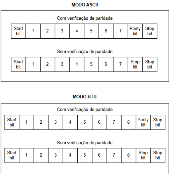
Figura 12 – Framing de dados nos modos ASCII e RTU.
