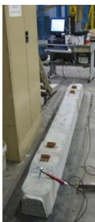
Figura 8: Arranjo de ensaio modal em dormente de concreto protendido
