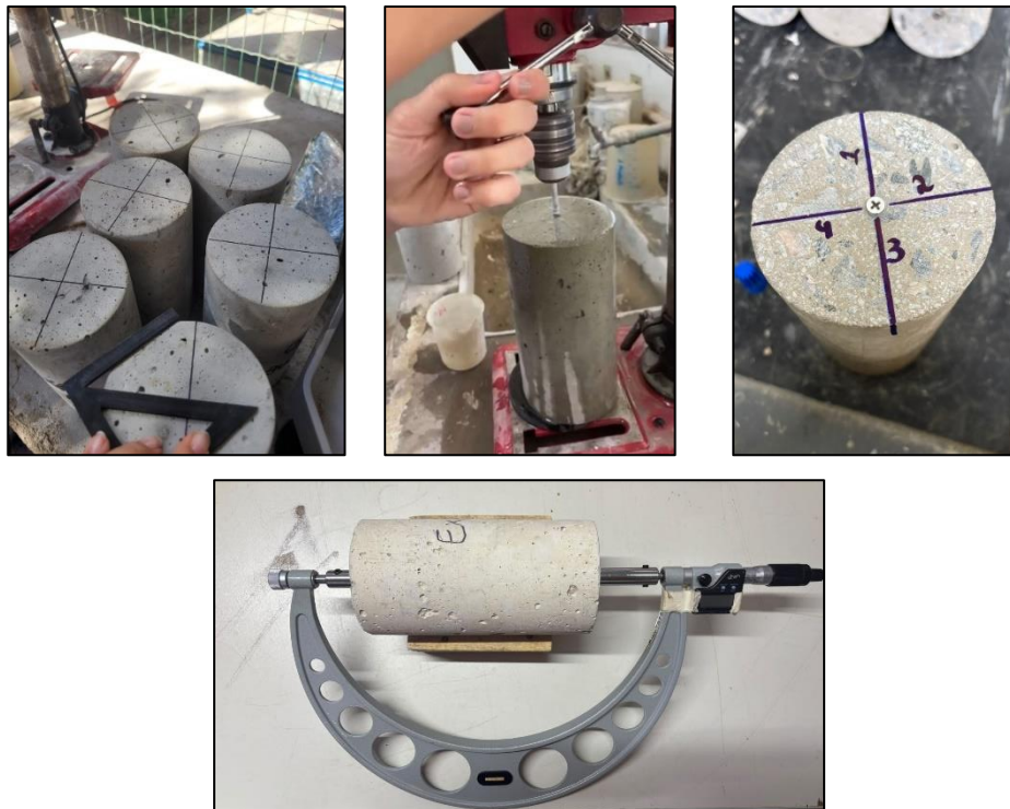
Figura 20: Medição de expansão em corpos de prova
