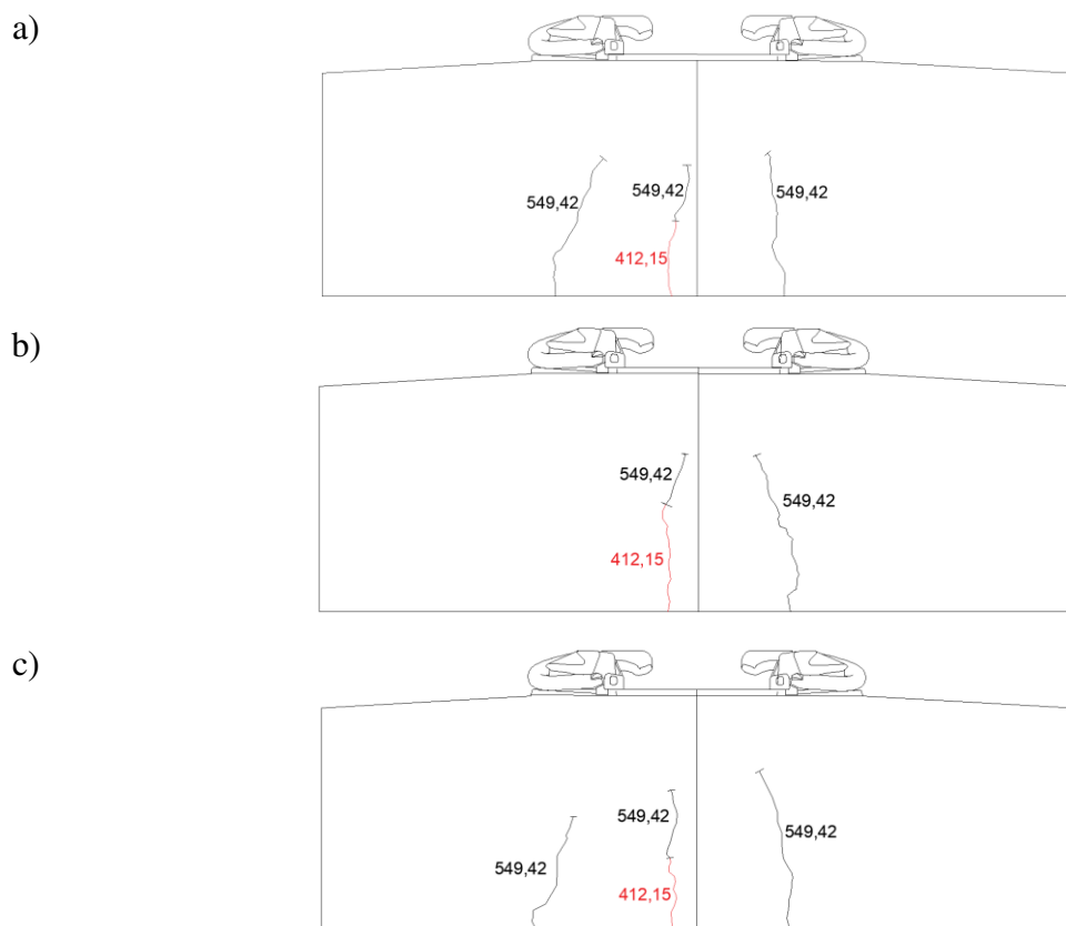
Figura 44: Evolução das fissuras pelo apoio do trilho – a) D4 b) D5 c) D6
