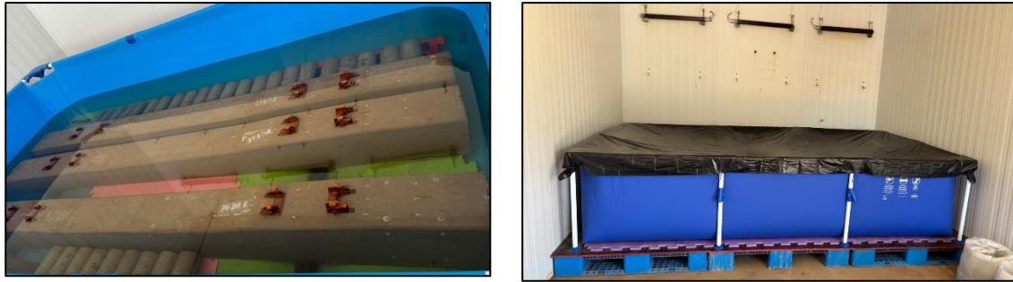
Figura 19: Dormentes imersos em solução na câmara de temperatura
