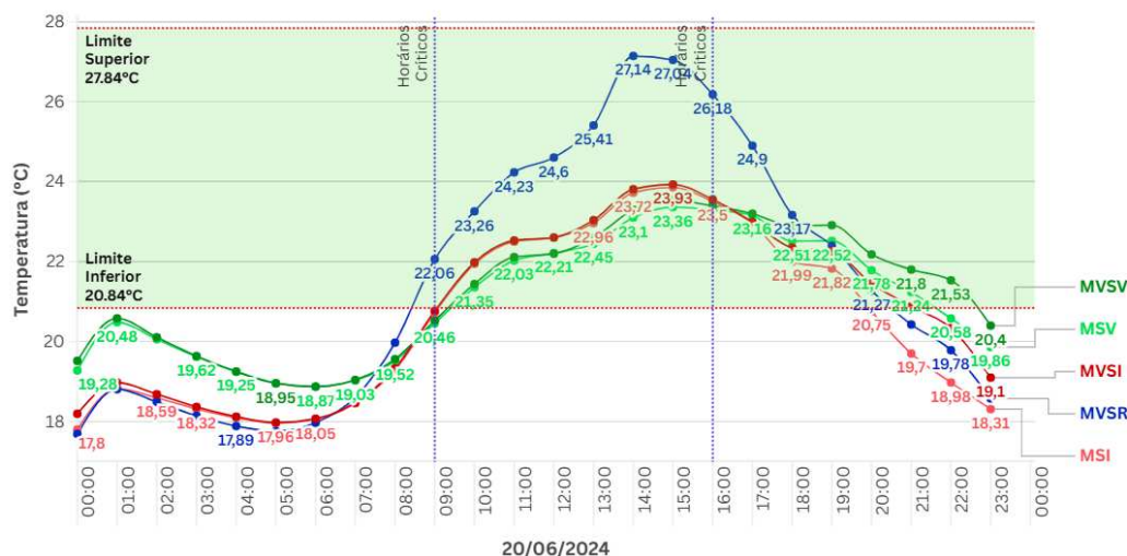
Figura 48 - Comportamento térmico verão dos módulos: MSV, MSI, MVSR, MVSV e MVSI.
