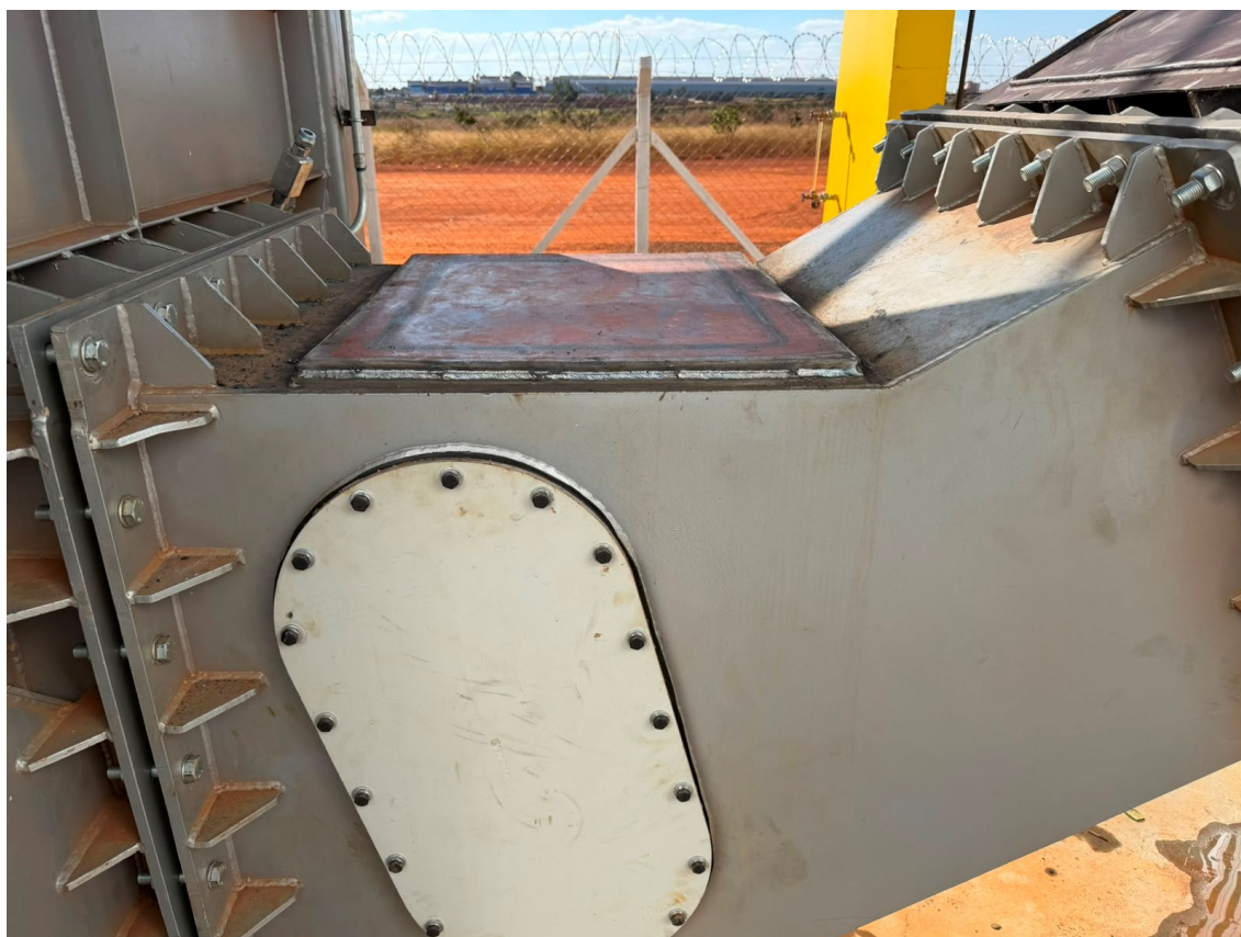
Figura 4.7 – Tampa superior soldada.
