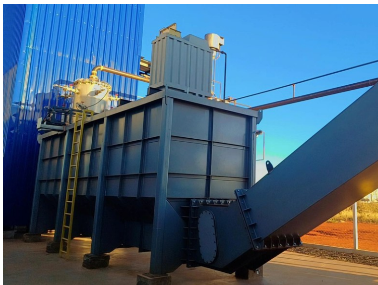
Figura 2.10 – Tanque de Decantação.
