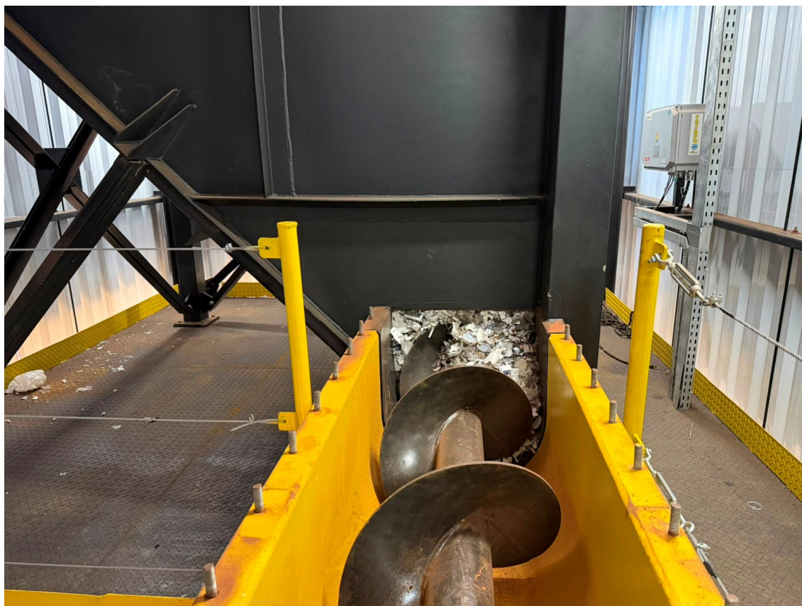
Figura 4.15 – Rosca alimentadora em teste.
