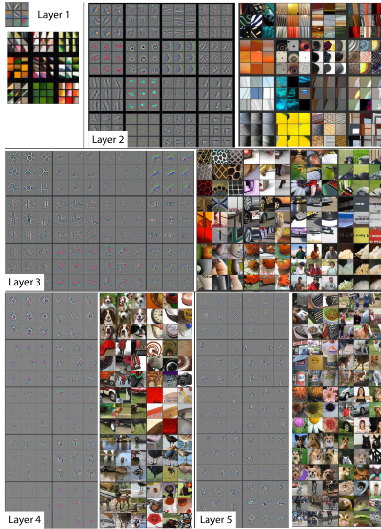
Figura 4 – Visualização das características aprendidas por uma CNN profunda em diferentes camadas: as camadas iniciais (Layer 1–2) capturam primitivas visuais como bordas, gradientes e padrões de textura simples; camadas intermediárias (Layer 3) combinam essas primitivas em representações mais complexas; camadas profundas (Layer 4–5) codificam partes de objetos e categorias semânticas. Para cada mapa de características, são exibidos os padrões que maximizam a ativação correspondente e os patches da imagem de validação que os ativam com maior intensidade. Adaptado de: Zeiler e Fergus (2014).
