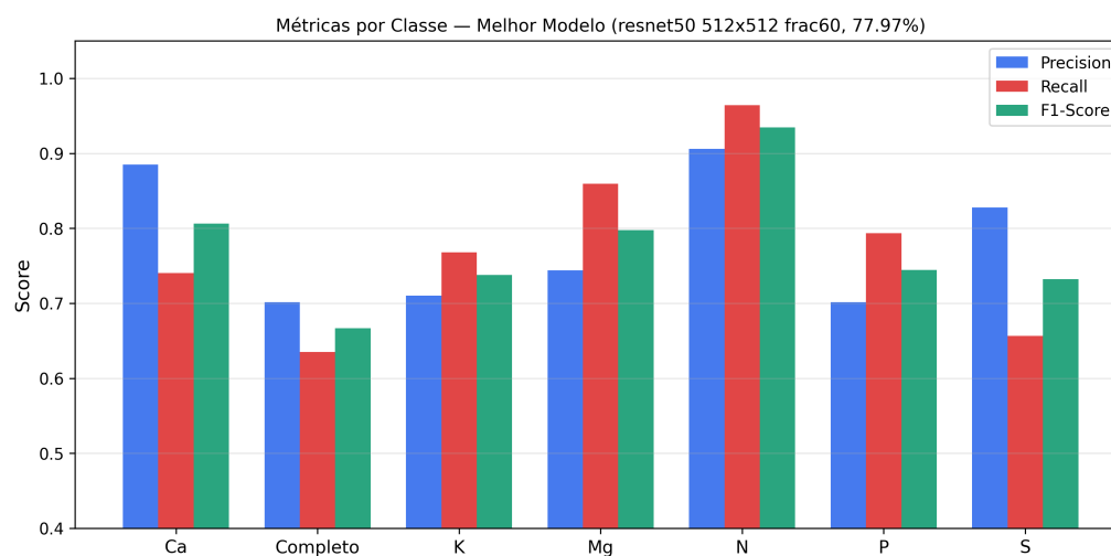
Figura 25 – Visualização das métricas de Precision , Recall e F1-Score por classe para o melhor modelo (ResNet50, 512 \times 512 , frac60). A deficiência de Nitrogênio apresenta métricas significativamente superiores às demais, enquanto as classes Completo e Enxofre exibem os menores F1-Scores.
