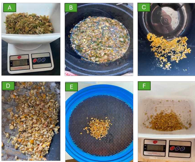
Figura 1 – Sequência de fotos do procedimento da separação hidrodinâmica dos grãos e seus fragmentos, seguido pela secagem, peneiramento e pesagem do material passante na peneira de 4,75 mm.
